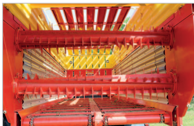
Vzhledem k intenzitě nasazení při sběru suché hmoty mají oba návěsy také stropní profily. Pro rovnoměrné vyložení zavádlé hmoty pak disponují dvojicí rozdrůzovacích válců. „Díky rozdrůzovacím válcům s menším průměrem jde hmota z ložné plochy rychleji ven; vyprazdňování je velmi rychlé,“ řekl řidič Roman Jindra mladší
