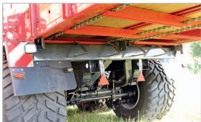
Tandemová náprava vozu Jumbo 7210 D s parabolickými pružinami a kyvadlem zaručuje návěsu podle vyjádření řidiče vynikající jízdní vlastnosti na poli i na silnici. Široké pneumatiky Nokian a vlečné řízení zadní nápravy slouží pro šetrné působení na půdu a travní drn. Svůj význam mají také přídatné světlomety za podvozkem, které se umí zapínat automaticky
