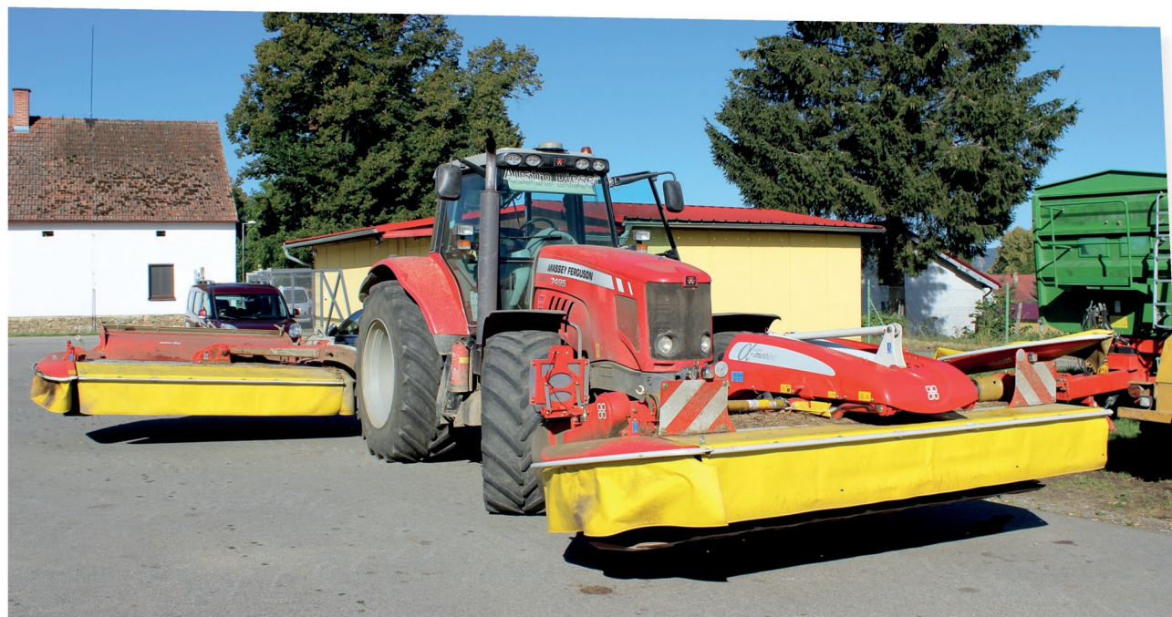
Kombinace žacích strojů NovaCat 302 ED a NovaCat 351 F ED Alpha Motion, firmy Pöttinger sklízí nejen louky, ale také pícniny na orné půdě včetně porostů ozimého žita na GPS ve dvofázové technologii. Žací stroje mají enormní průchodnost a kvalitní kopírování půdy
