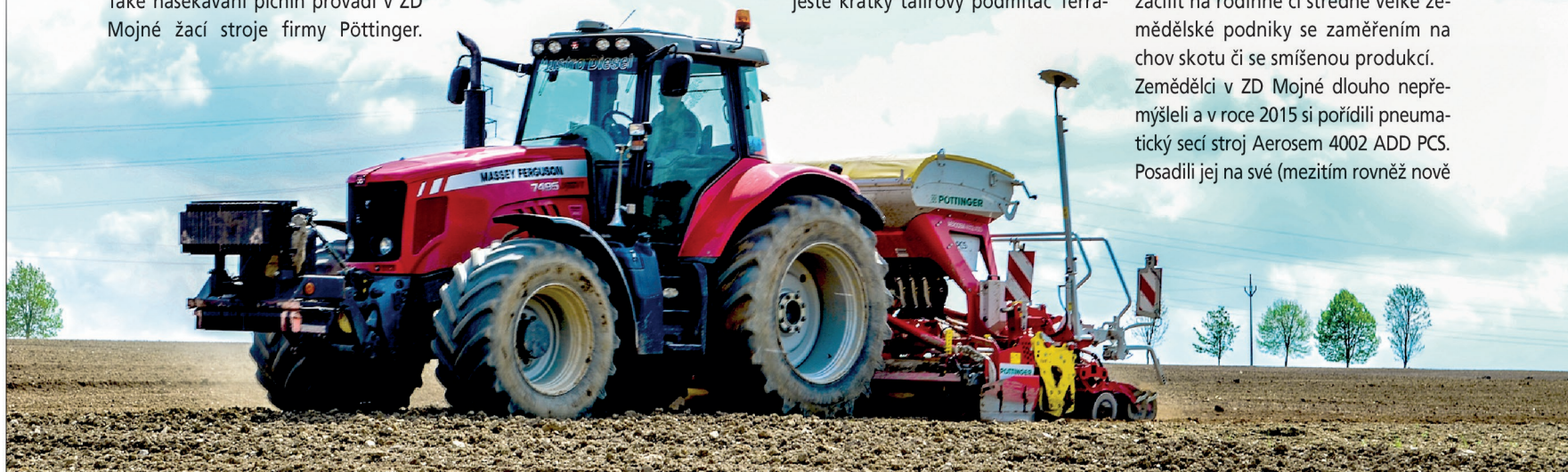
Spokojenost s fungováním strojů značky Pöttinger a možnosti víceúčelového využití byly v ZD Mojné hlavními důvody pro pořízení secí kombinace Aerosem 4002 ADD PCS. Integrovaný systém pro setí jednotlivých zrn PCS dovoluje i výsev širokořádkových plodin
