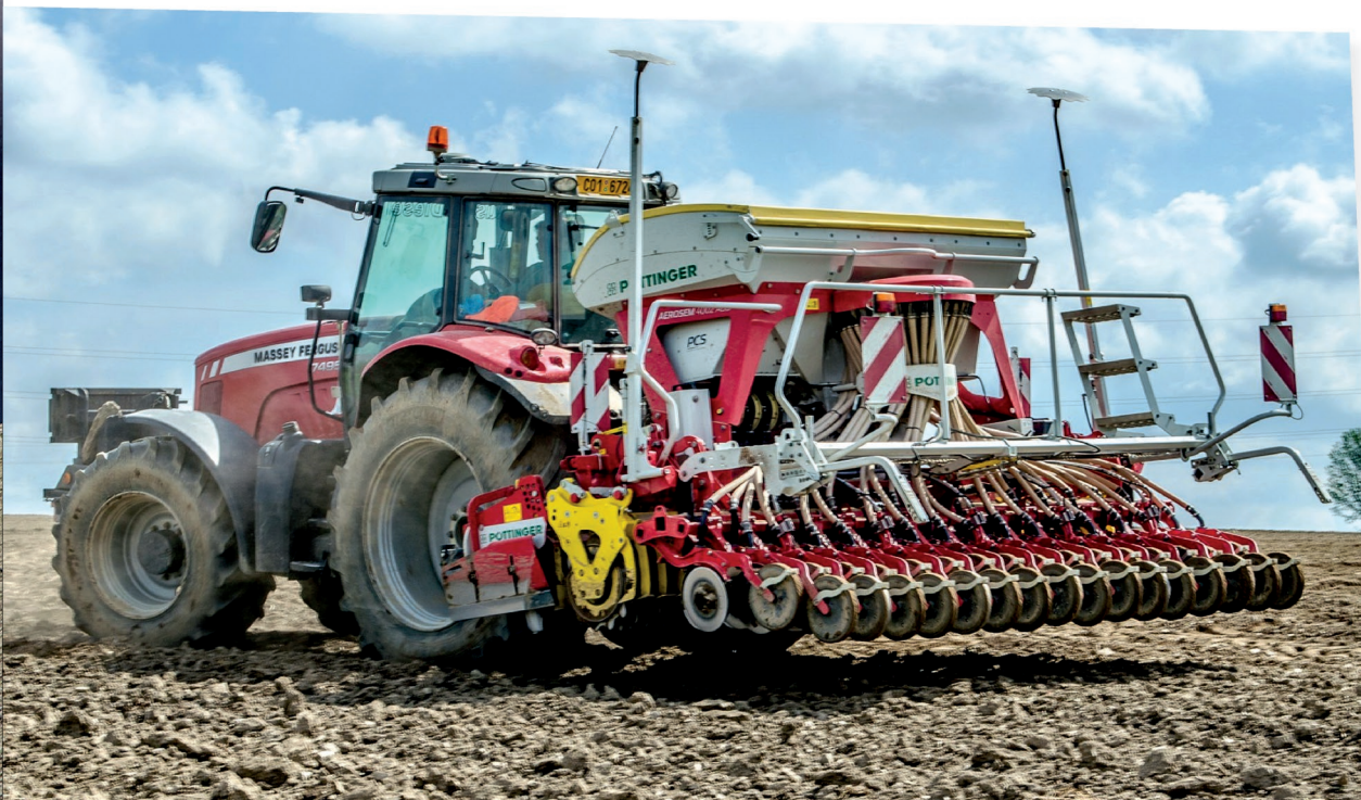
Traktor Massey Ferguson 7495 Dyna-VT na pneumatikách Michelin XeoBib zvládá secí kombinaci hravě jak z hlediska zvedací síly, tak i při samotné práci. Kukuřice se vysévá přímo do hrubé brázdy, s níž si dlouhé hřeby rotačních bran Lion 4002 snadno poradí
