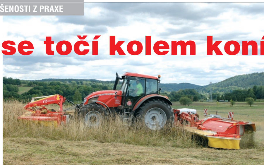
Disková žací kombinace NOVACAT X8 ED s čelním žacím strojem NOVACAT 306 F ED pracuje v agregaci s traktorem Zetor o výkonu motoru 150 k bez potíží i v náročném kopcovitém terénu.
