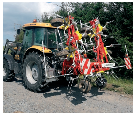
Osmirotorový obraceč HIT 8.81 se záběrem 7,70 metru. Malý průměr rotorů (1,30 metru) zaručuje vynikající přizpůsobení nerovnostem a šetrnou manipulaci s posečenou pící.
