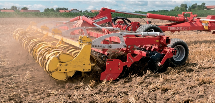
TERRADISC s pracovním záběrem 8 metrů je agregovatelný s traktory s výkonem od 270 do 400 k.
