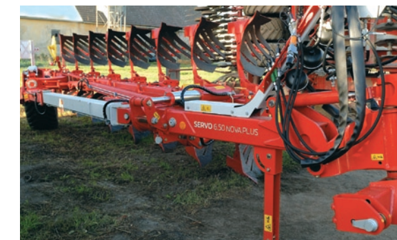
Osmíradličný pluh SERVO PLUS NOVA s hydraulicky nastavitelným pracovním záběrem a s NONSTOP jištěním pracovních orgánů proti kamenům je vhodný pro orbu do všech půdních podmínek.
