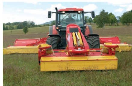
Disková žací kombinace NOVACAT X8 ED s čelním žacím strojem NOVACAT 306 F ED pracuje v agregaci s traktorem Zetor o výkonu motoru 150 k bez potíží i v náročném kopcovitém terénu.
