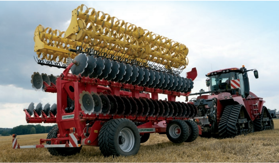
Robustní konstrukcí vyniká také podvozek. Speciální systém sklápění do přepravní polohy má zásluhu na tom, že i největší model diskového podmítače TERRADISC 10001 T se převáží po silnici s výškou jen čtyři metry a s šířkou pouhých tří metrů.
