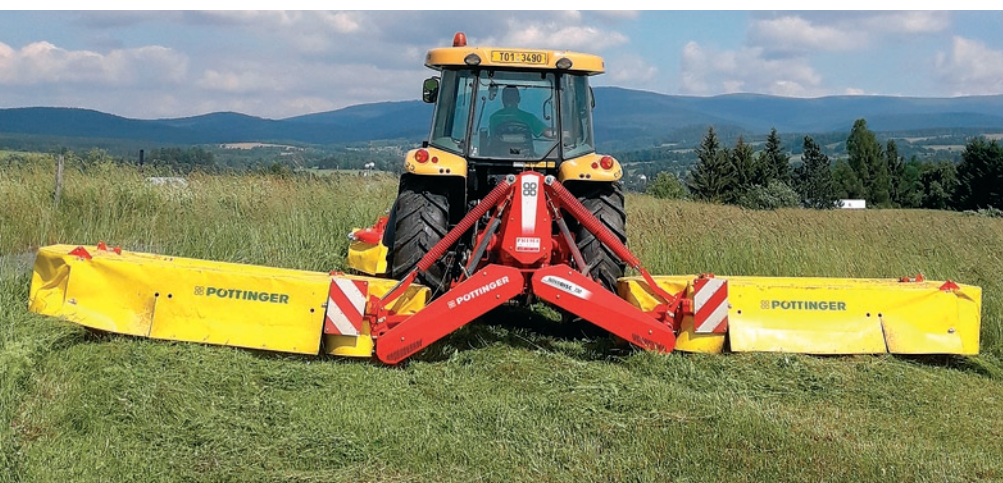
Výkonná žací kombinace NOVADISC 730 s čelní žací lištou NOVACAT 301 F alpha motion.
