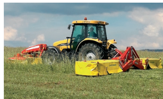
Pro kvalitní práci žací kombinace NOVADISC 730 s pracovním záběrem 7,24 metru, a to i v kopcovitém terénu, stačí traktor o výkonu motoru 117 k.
