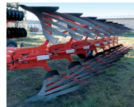
Osmíradličný pluh SERVO PLUS NOVA s hydraulicky nastavitelným pracovním záběrem a s NONSTOP jištěním pracovních orgánů proti kamenům je vhodný pro orbu do všech půdních podmínek.
