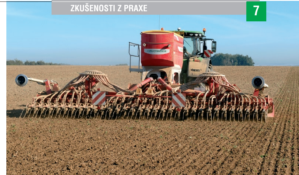
Univerzální secí stroj TERRASEM C8 ARTIS se perfektně přizpůsobuje půdě i při velkém pracovním záběru.
