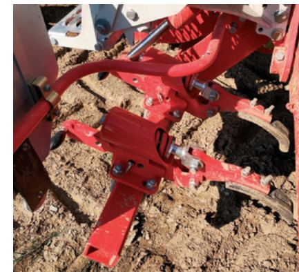
Secí stroj TERRASEM C6 je na přání vybaven kypřičem stop po kolech traktoru.
