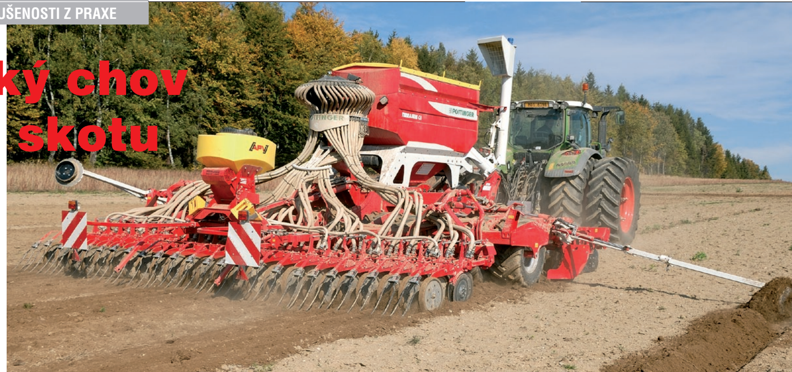
Univerzální secí stroj TERRASEM C6 se záběrem šest metrů doplňuje zařízení pro setí meziplojin. V AGRO Huzová tak jedním přejezdem vyřeší přípravu půdy před setím a následné setí pelušky a hořčice na zelené hnojení. Plnění zásobníku na osivo s objemem 3 950 litrů urychluje integrovaný hydraulický plnicí šnek v přední části stroje.
