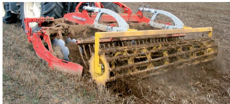
Nesený diskový podmičák TERRADISC 3001 kvalitně zpracuje a promíchá půdu do hloubky 3 až 12 cm.
