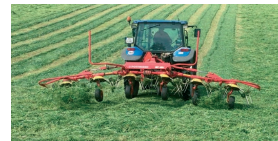
Obrabeč EUROHIT 610 N výborne kopíruje nerovnosti a šetrne manipuluje s hmotou.
