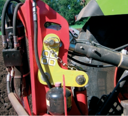
Trakční posilovač TRACTION CONTROL u pluhu Pöttinger v praxi jednoznačně potvrzuje účelnost tohoto systému, která se projevuje nižší energetickou náročností orby a vyšší výkonností.
