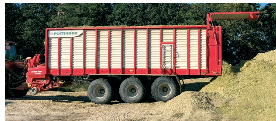
Univerzálny veľkoobjemový voz JUMBO 10010 L COMBILINE na zber senáže a odvoz objemových krmív.
