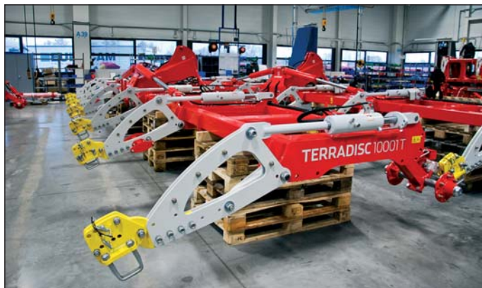
Diskový podmietač Terradisc 10001T v procese montáže. Aktuálne stroj na spracovanie pôdy s najväčším pracovným záberom od Pöttingeru.
