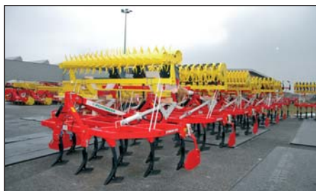
Kypriče Synkro sa vyrábajú s dvoma a tromi radmi radličiek. Stroj je v zadnej časti vybavený ešte utužovacím valcom, s možnosťou viacerých typov do rôznych pôdnych podmienok.
