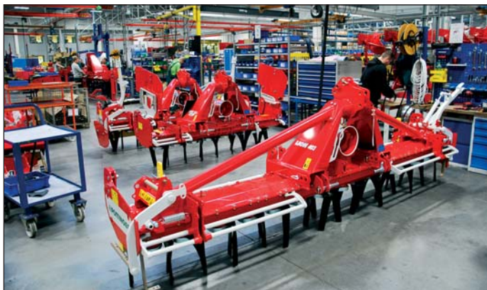
Rotačné brány Lion je ideálne kombinovať so sejacími strojmi Vitaseom a Aerosem. Na snímke finalizácia modelu Lion 403.
