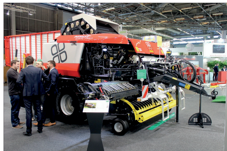
Sortiment lisů na válcové balíky Impress rozšiřují nové kombinace lisu s ovíječkou. Balík je po slisování ihned zabalený, což má pozitivní vliv na kvalitu výsledného krmiva. Dvě operace lze provádět při jednom přejezdu, což znamená úsporu nákladů, pracovních sil i času
