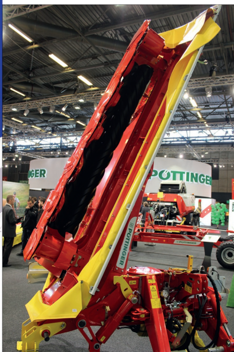
Vzadu nesený žací stroj NovaCat 352 RCB prezentoval nový válcový mačkač, u kterého doposud používaný řetězový pohon vystřídaly dva ozubené řemeny. Možná dráha vychýlení horního válce se zdvojnásobila, předpětí řemenů je jednoduše nastavitelné a pohon je zcela bezúdržbový
