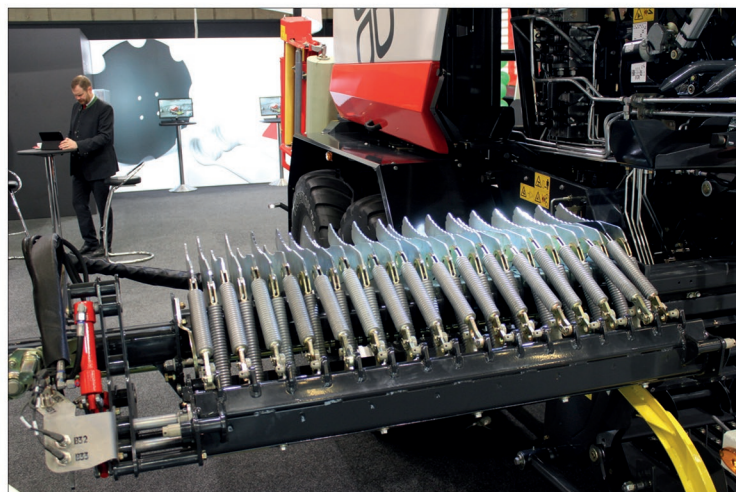
Také kombinace Impress jsou vybaveny originálním výsuvným nosníkem nožů Flexcut, který je osazený 32 noži Twinblade s oboustranným ostrím a s nonstop jištěním každého nože. Výměnu nožů lze provádět ve vzpřímené poloze u nosníku nožů, který je vysunutý vedle lisu
