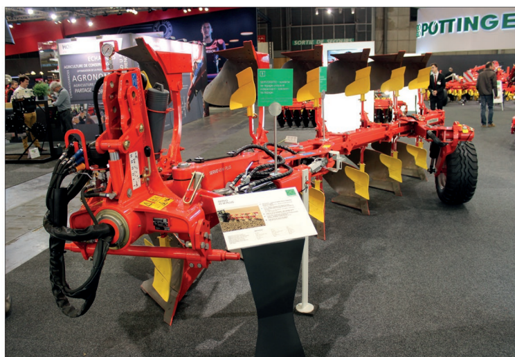
Servo 45 M je nová řada nesených pluhů firmy Pöttinger pro traktory s výkonem od 140 do 240 k. Na veletrhu SIMA byla představena nejnovější varianta se šesti páry orebních těles, navíc ještě vybavená předradličkami a systémem Traction Control (pístnice a speciálně tvarovaná vidlice v závěsu pluhu)
