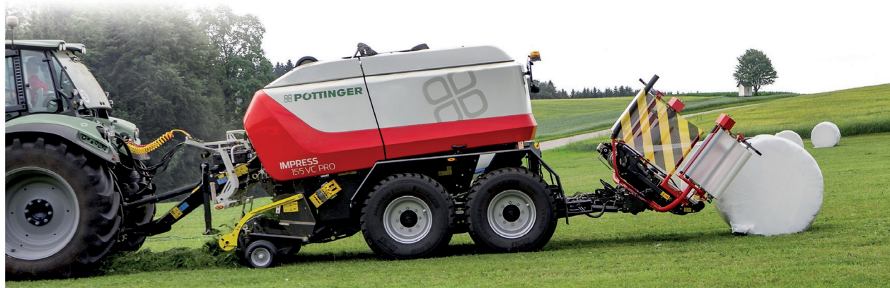
Skližeň zavádějí píče do balíků, je oblíbenou technologií také v podhorských oblastech, ale přenosová jednotka dokáže spolehlivě fungovat i na strmých svazích. Další výhodou kombinace je to, že zabalený balík lze převézt a odložit až na vhodnějším místě
