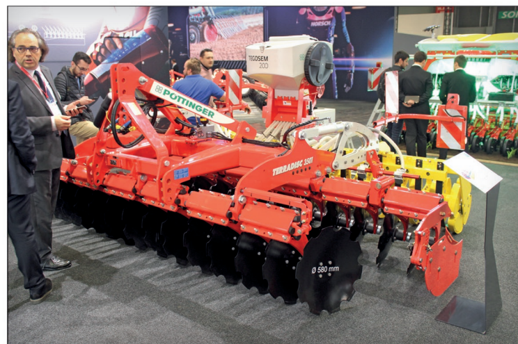
Nesený model podmiťáče Terradisc 3501 s pracovním záběrem 3,5 m byl doplněn o secí stroj pro přisevy Pöttinger Tegosem 200. Secí stroj je koncipován tak, aby umožňoval výsev všech druhů plodin, od hořčice přes jeteloviny a trávy až po hrachy či boby v širokém spektru výsevků
