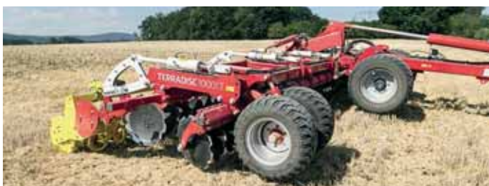
Na úvratí Terradisc spočíva na zadnom tandemovom valci. Kopírovacie a prepravné kolesá vpredu nemajú v tomto prípade žiadnu funkciu.
