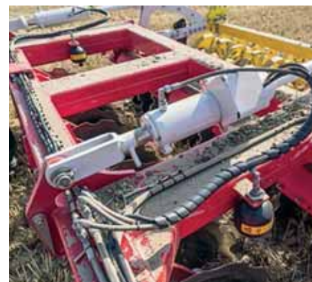
Polohový senzor riadi dráhu piestnice milimetrovou presnosťou.
