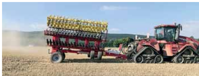
Najskôr hydraulický valec zdvihne pracovnú sekciu kolmo nad podvozok. Následne sa sklopia obe krídla a uložia sa na oje a podvozok sa zníži.
