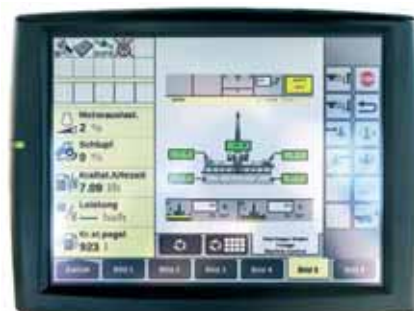
Celé náradie viete ovládať IsoBus terminálom. Mohlo to byť aj voliteľným tlačidlom na joysticku, čo je ale drahší komfort.
