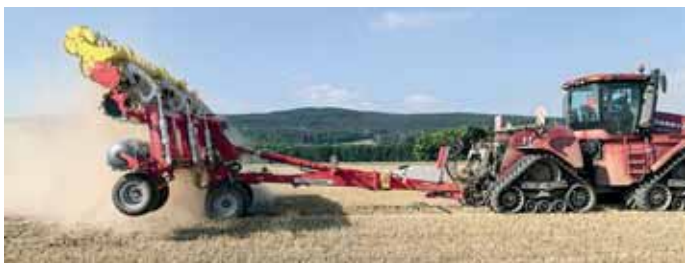
Najskôr hydraulický valec zdvihne pracovnú sekciu kolmo nad podvozok. Následne sa sklopia obe krídla a uložia sa na oje a podvozok sa zníži.
