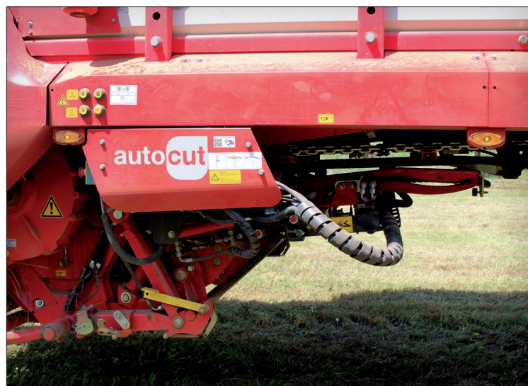
Automatický systém broušení nožů Autocut pracuje s jedním brusným kotoučem, který obnovuje nabroušení jeden po druhém u všech nožů. Brousící hlava je ve svém pohybu vedena v kulisové dráze s ozubenou lištou a přítlak brusného kotouče je nastavitelný
