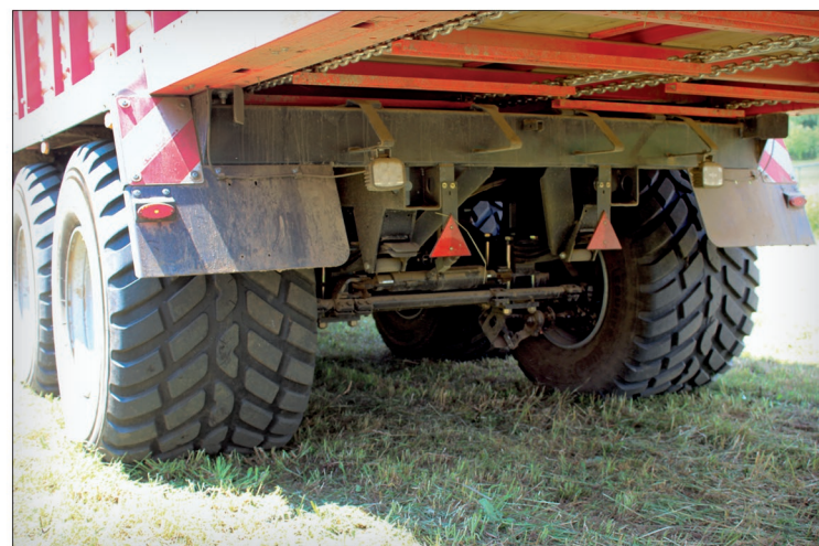
Kromě mechanického existuje také příplatková varianta s odpružením hydropneumatickým, doplněným případně ještě integrovaným vážicím systémem. Nicméně mechanické odpružení je také velmi účinné při tlumení rázů, přičemž stabilizační vzpěry se starají o to, aby se vůz nenakláněl ve svazích
