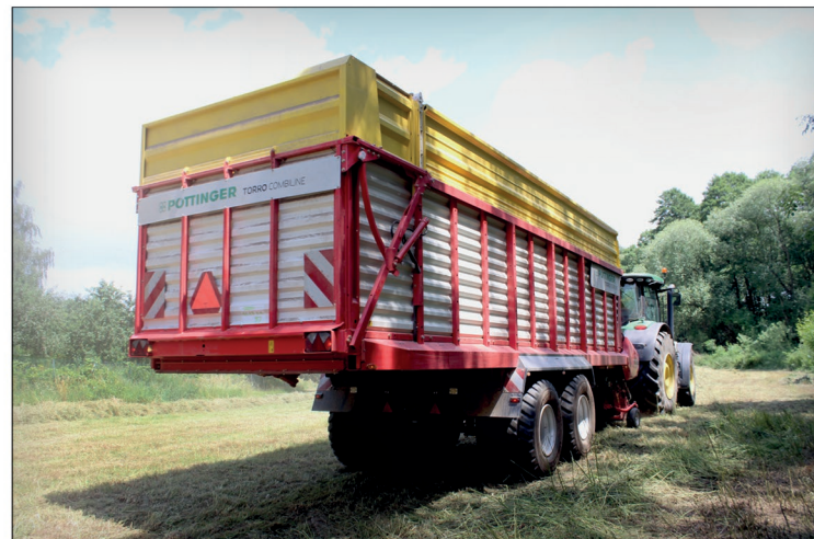
Nová multifunkční zadní stěna je namísto plachty vybavená plechovým zakrytím. Toto řešení zabraňuje ztrátám materiálu v průběhu přejezdů. Díky novému pohonu dávkování, který poskytuje systém vyprazdňování návěsu výkon 160 kW, dokáže návěs Torro Combiline vyložit veškerou hmotu v rekordně krátkém čase
