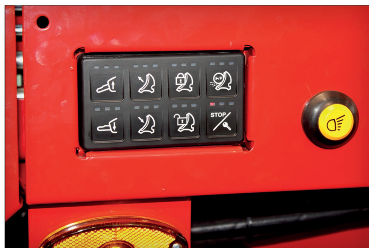
Postranní ovládací panel s novým uspořádáním nových návěsů Torro 7010 a 8010 Combiline umožňuje prostřednictvím tlačítek se zřetelnými symboly řídit řezací ústrojí, systém automatického broušení Autocut, řetězový dopravník a je také možné ovládat připojení a odpojení návěsu od traktoru
