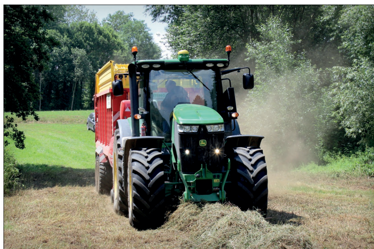
Víceúčelové návěsy Torro 7010 a 8010 Combiline nabízí velkou kapacitu ložné plochy, vysokou technickou úroveň, dokonce překonávající královskou třídu vozů Jumbo, ale zároveň kompaktní rozměry pro práci v členitých pozemcích s úzkými vjezdy. Návěs Torro 8010 L Combiline pojme 3,5 t sena
