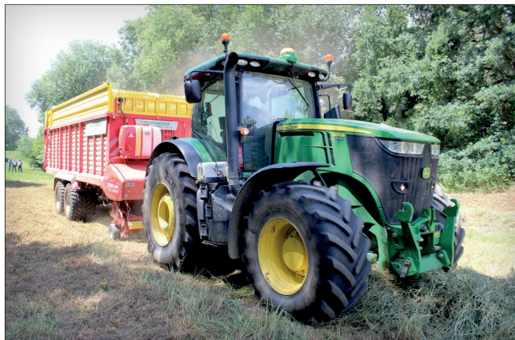
Traktor John Deere 7270R s převodovkou e23 zvládá návěs Torro 8010 L Combiline hladce. I když by bylo možné ovládání vozu na terminálu CommandCenter 4600 prostřednictvím ISOBUS, tak k tomu účelu slouží terminál Powercontrol. Ten je dodáván sériově, případně může pracovat i bezdrátově
