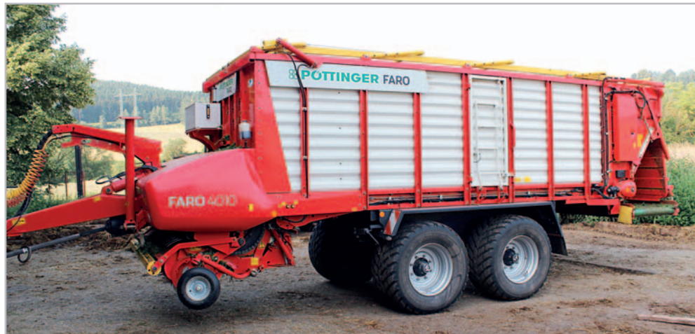
Návěs Faro 4010 D s hustě uspořádanými a přišroubovanými sloupky je dostatečně robustní. U jedné fůry pojme pět až šest tun zelené hmoty Foto Petr Beneš
