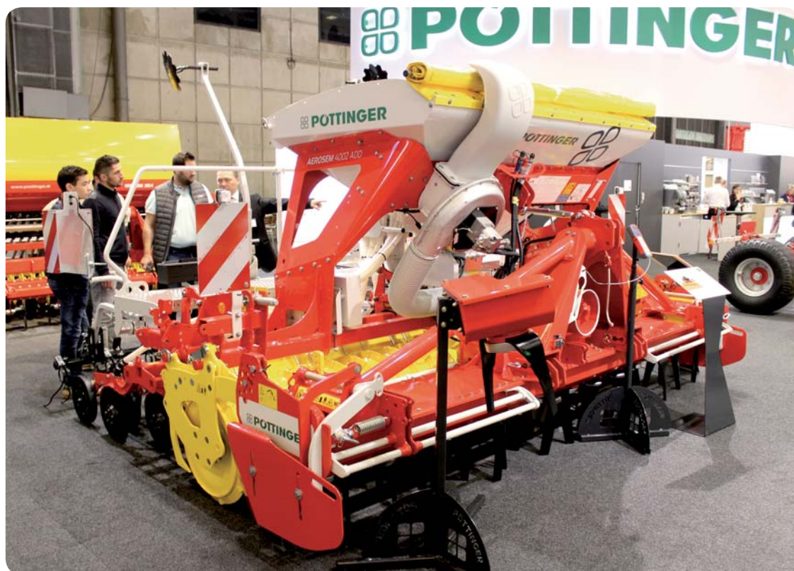
Distribuční systém IDS zaručuje konstantní počet zrn ve všech řádcích i při zakládání kolejových řádků. Prezentoval jej pneumatický secí stroj Aerosem 4002 ADD
