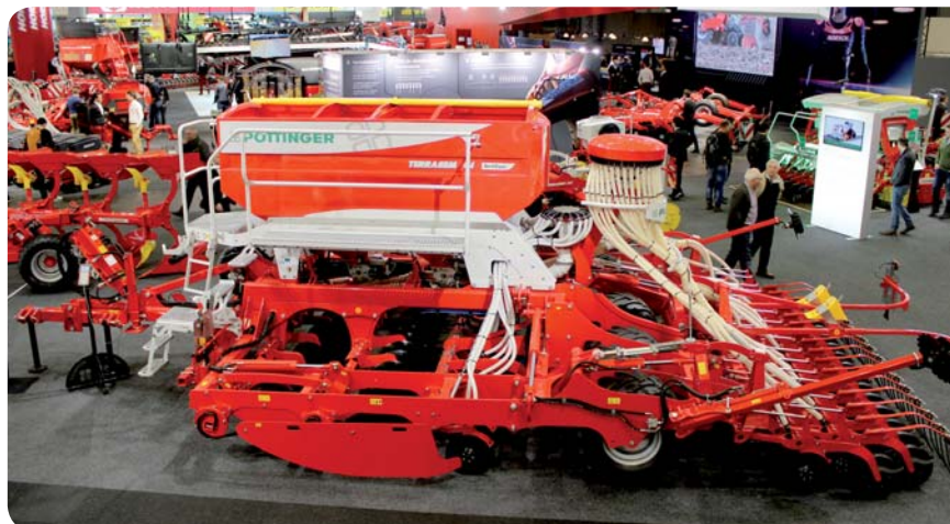
Secí stroje Terrasem fertilizer jsou kromě druhého dávkovacího zařízení vybaveny ještě přidavným rozdělovačem, od něhož vedou hnojivo hadice k samostatné řadě dvoudiskových botek
