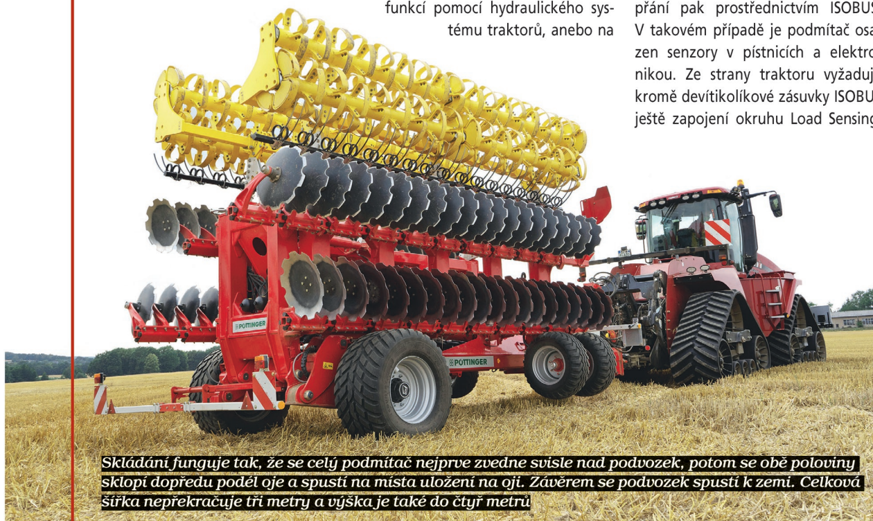
Firma Pöttinger představuje nové krátké talířové brány Terradisc 8001 T a 10001 T. Velký model Terradisc 10001 T má na svůj pracovní záběr deseti metrů hmotnost 13 t
