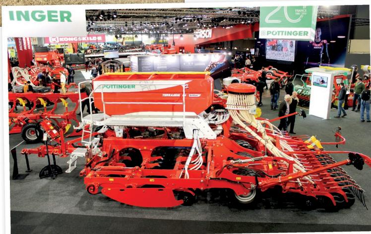
Pneumatické secí stroje Terrasem mohou být vybaveny předřazenou sekcí s označením Wave disc. Tvarované talíře provádí mělké kypření půdy pouze v pruzích – zpracovávají drážku, určenou k uložení osiva, se šírkou zhruba 50 mm. Zbývající plocha zůstává bez zpracování
