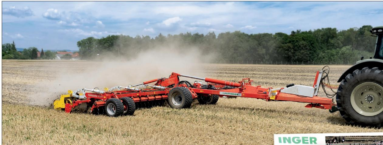
Zajímavostí největších podmítaců firmy Pöttinger je na přání nabízené ovládání prostřednictvím ISOBUS. Kromě jednodušší agregace s traktorem to přináší i možnost nastavení tlaku v pístnicích sklápění obou bočních polí podmítace či precizní přestavení pracovní hloubky stiskem tlačítka na terminálu v kabině traktoru
