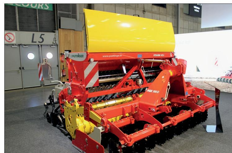
Výhodou krátké kombinace Fox D při agregaci s nástavovým secím strojem je kompaktní uspořádání, nízká hmotnost a dobrá práce při vyšších pojazdových rychlostech
