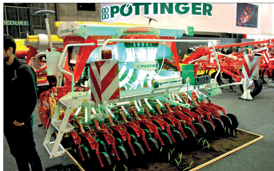
Pneumatický secí stroj Aerosem 3002 ADD efektně prezentoval možnost výsevu kukuřice do řádků 75 cm se současným setím další plodiny do meziřádkového prostoru pomocí systému IDS
