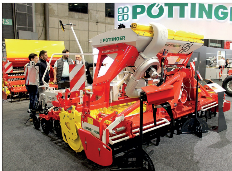
Pneumatický secí stroj Aerosem 4002 ADD byl vybaven distribučním systémem IDS, který zaručuje konstantní počet zrn ve všech řádcích i při zakládání kolekových řádků. Systém umožňuje realizovat i automatické vypínání sekcí podle polohy při vjíždění do klínů
