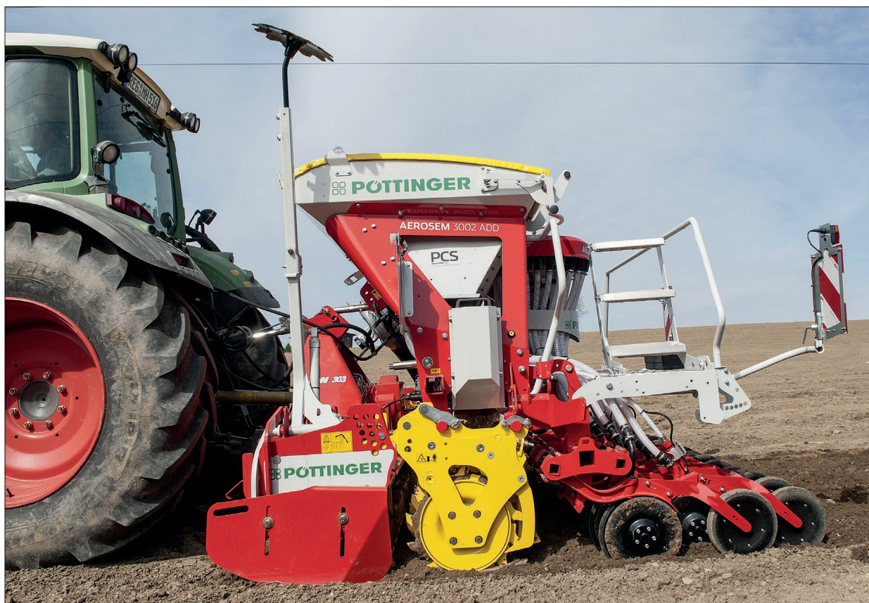
S technologií Duplex Seed je možné setí silážní či zrnové kukuřice do dvouřádku. K hlavním přínosům patří zvýšení výnosu hmoty či zrna o deset procent a zvětšení výkonnosti při setí díky možnosti zvýšení pojízdné rychlosti
