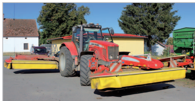
Kombinace žacích strojů NovaCat 302 ED a NovaCat 351 F ED Alpha Motion firmy Pöttinger sklízí nejen louky, ale také pícniny na orné půdě včetně porostů ozimého žita na GPS ve dvoufázové technologii. Žací stroje mají enormní průchodnost a kvalitní kopírování půdy
