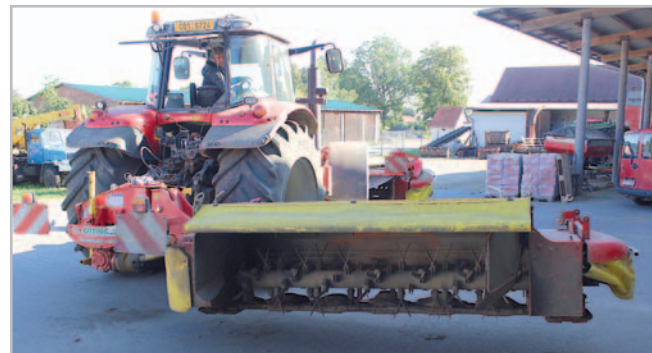
Posečená hmota je od rychle se otáčejících disků žacích strojů NovaCat ED odebrána rotorem kondicionéru. Jeho prsty naruší povrchovou vrstvu píce a zároveň hmotu načechnají, čímž se zavádění na třicetiprocentní obsah sušiny urychlí
