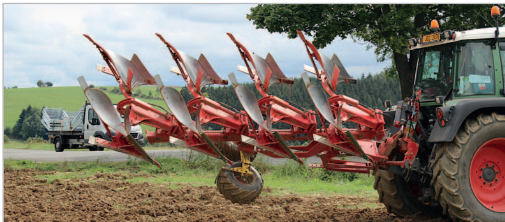
Vybrané verze nesených pluhů Servo mohou být na přání vybavené paměťovým memory válcem. Dvojitá pístnice se v průběhu otáčení neseného pluhu stará o přiblížení rámu směrem k podélné ose pluhu a poté o automatické obnovení původního záběru. Foto Petr Beneš
