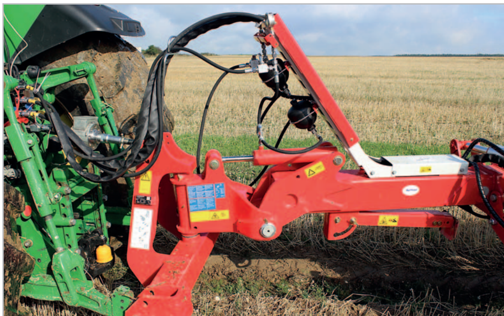
Systém Traction Control u polonesených pluhů Servo 6.50 snižuje prokluz zadních kol traktoru, a zároveň snižuje rozdíl v zatížení záhonového kola a kola jedoucího v brázdě. Foto Petr Beneš
