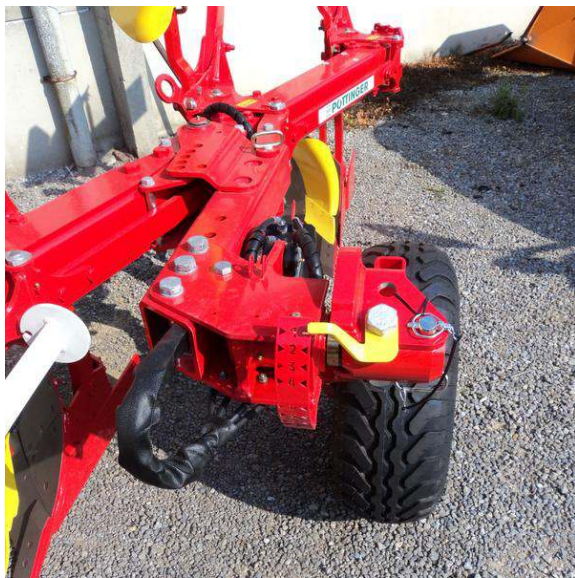
Le réglage de l'aplomb permet aux corps d'adopter une verticalité parfaite au travail. N.H.
