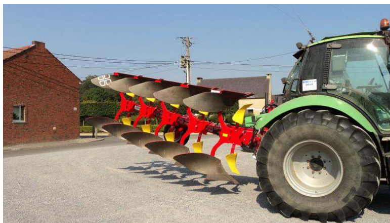
Si les bras de relevage doivent rester libres au travail, il ne faut pas oublier de resserrer les stabilisateurs au transport pour sécuriser les déplacements routiers. N.H.
