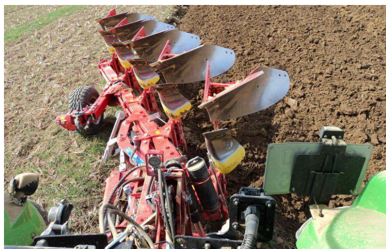
Lorsque la charrue est bien réglée, aucune discontinuité n'est visible entre les différents passages. N.H.
