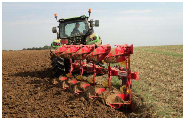
Le réglage de l'aplomb permet aux corps d'adopter une verticalité parfaite au travail. N.H.
