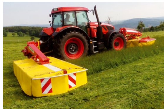
Šestimetrová žací kombinace s čelní lištou NOVACAT 301 ALPHA MOTION a zadní lištou NOVACAT 352.
