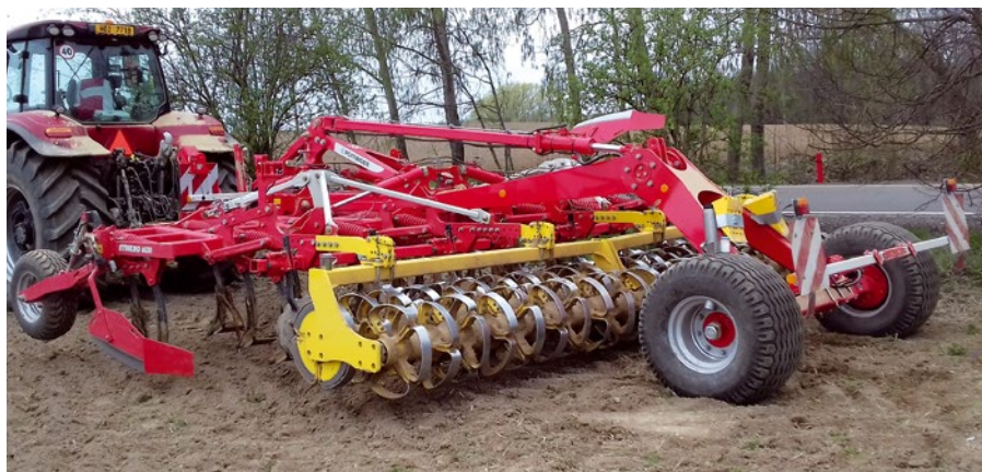
Radličkové podmiťáče mají v Sobotce dva. Na snímku je SYNKRO 6030 T NOVA se záběrem šest metrů.
