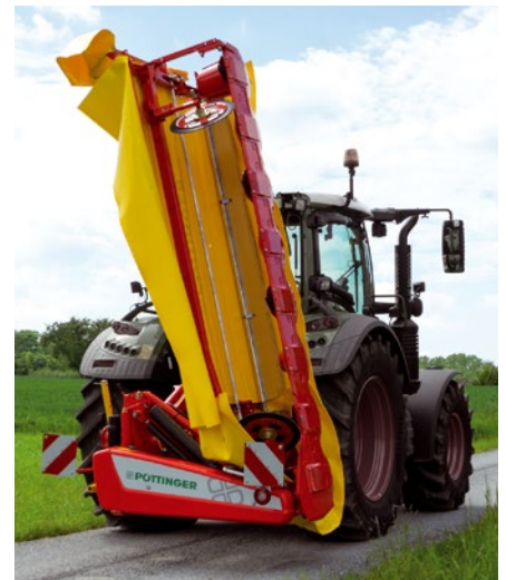
Novinkou zadně nesených žacích strojů NOVADISC je optimalizované těžiště strojů pro bezpečnou a kompaktní silniční dopravu.
