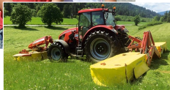
Žacia kombinácia NOVADISC 730 s čelnou lištou NOVACAT 301 ALPHA MOTION s pracovným záberom 7,3 m agregovaná v traktore Zetor o výkone 120 k.
