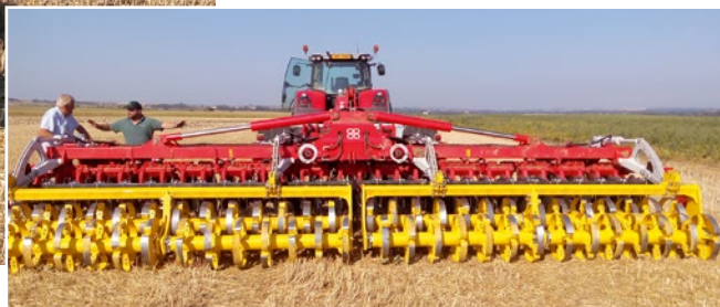
Polonesený diskový podmiítač TERRADISC 8001 T s pracovním záběrem osm metrů.
