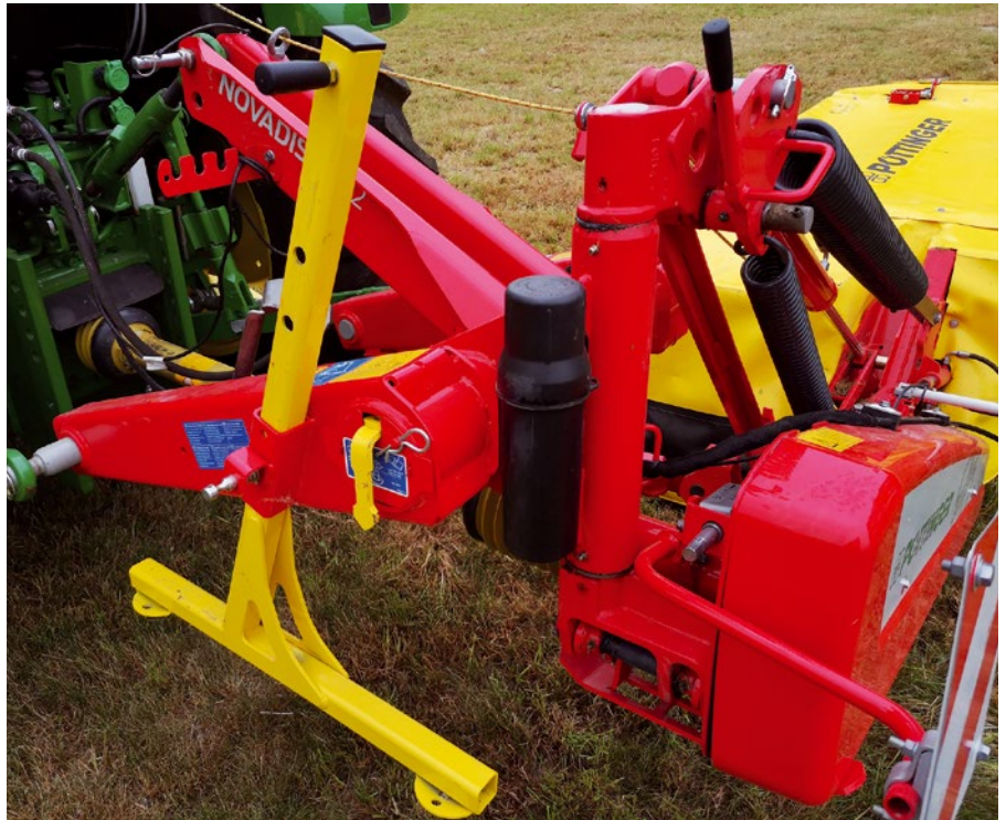
Nastavení odlehčení bez nutnosti použití nářadí, odstavné patky a osvětlení LED jsou jen některými vylepšeními nových žacích strojů NOVADISC, které zpřijemňují život uživatelům.
