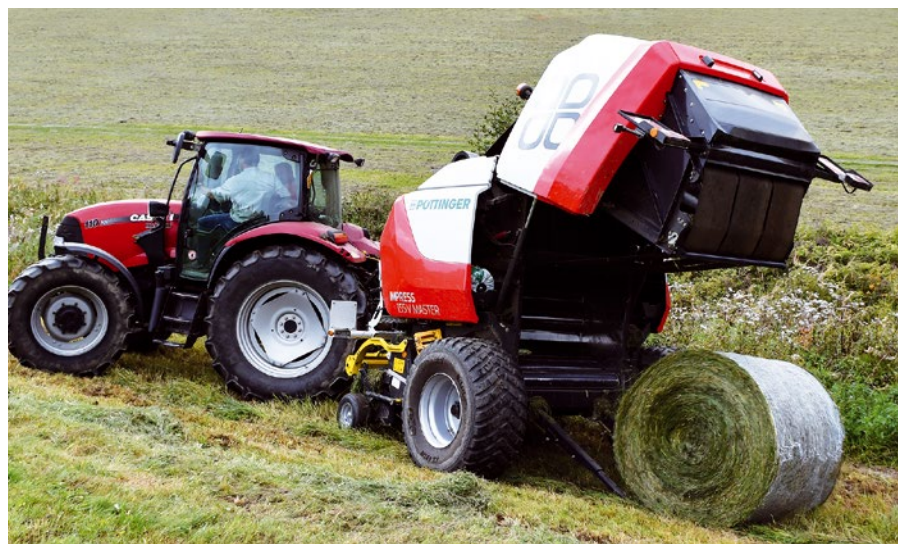
Lis s variabilní komorou IMPRESS 155 V MASTER je vybavený řezacím ústrojím s 16 noží.
