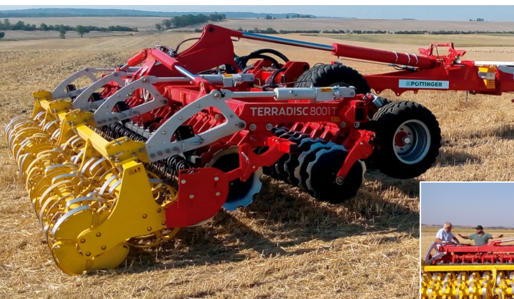
Polonesený diskový podmiítač TERRADISC 8001 T s pracovním záběrem osm metrů.
