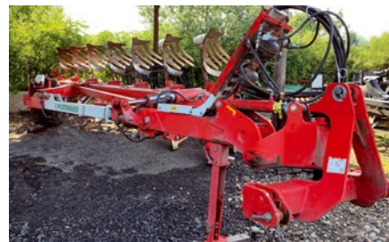
Sedmiradičný pluh SERVO 6.50 NOVA je na farmě sedm sezon a používají ho podle potřeby. Letos před řepkou zpracoval 150 hektarů do hloubky 35 cm.
