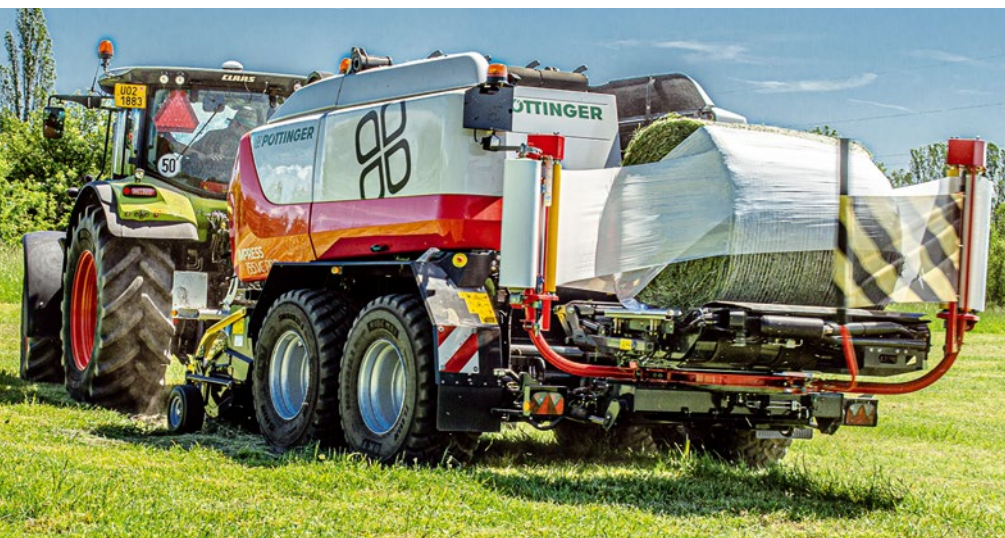
IMPRESS 155 VC PRO je výkonný lis s integrovanou ovíječkou, který zvládne dvě operace při jedné jízdě.
