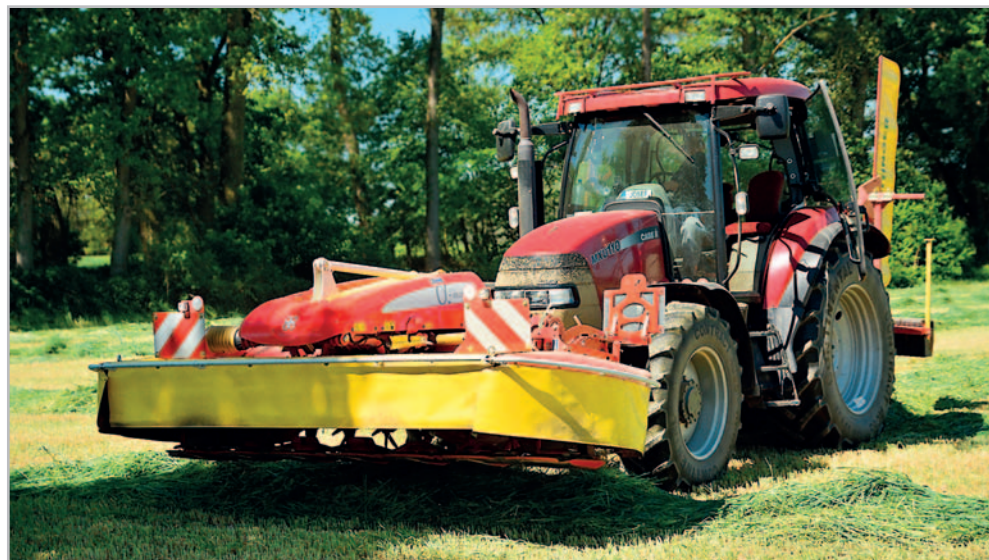
Čelně nesený žací stroj NovaCat 301 FED v závěsu alpha-motion s prstovým kondicionérem vyniká nejen svým kopírováním terénu, ale i účinným odlehčením prostřednictvím vinutých pružin
