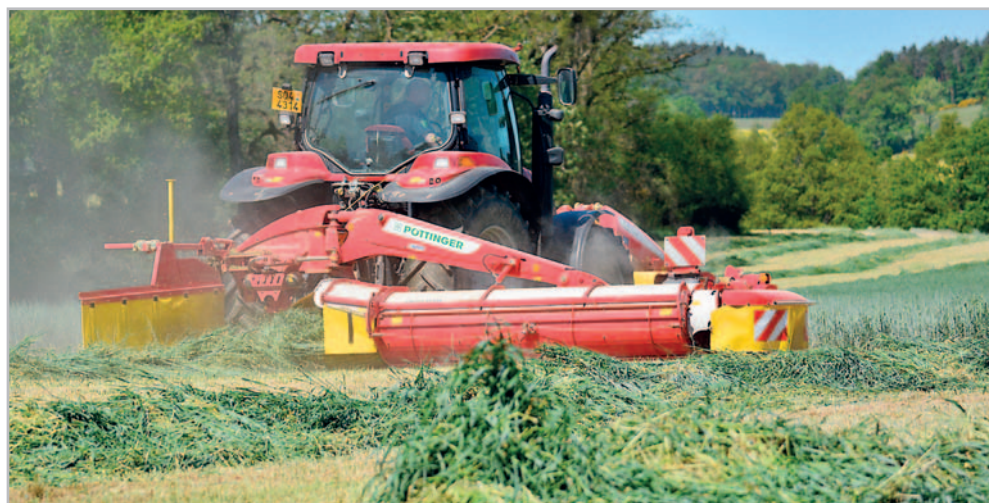
U žací dvojkombinace, u které je vzadu nesený žací stroj osazený šnekovým dopravníkem Cross Flow, je hmota od tohoto žacího stroje ukládána na středový řádek bez nutnosti použití prstového lamače a následného shrnování. Tím se ušetří jedna pracovní operace, palivo a čas
