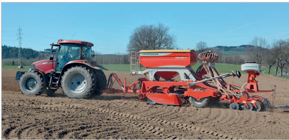
Spojení secích strojů Terrasem R3 a Pöttinger Tegosem dovoluje vysévat dvě plodiny při jedné jízdě najednou, kterými jsou na Farmě Pešta hrách s podsevem jetele
