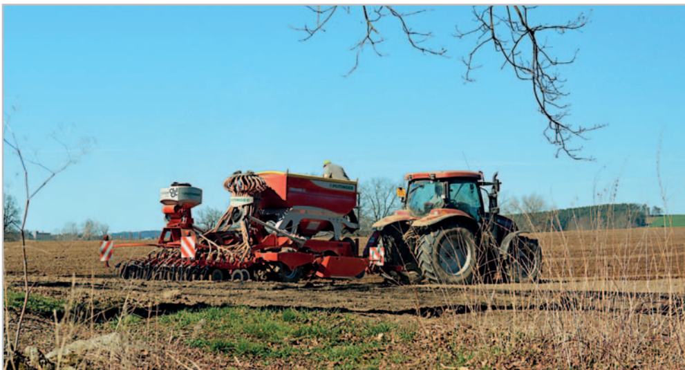
Výsev probíhá do zorané půdy ošetřené smykáním. Secí stroj Terrasem R3 zvládne založit porosty na třiceti hektarech denně
