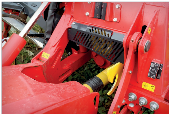
Vstupní převodovka Y Drive u žací kombinace NovaCat A9 a A10 je koncipována tak, že hnací kloubové hřídele svírají méně ostrý úhel a mohou být díky tomu i delší. Menší úhel má vliv i na prodloužení životnosti a chod pohonu je tichý
