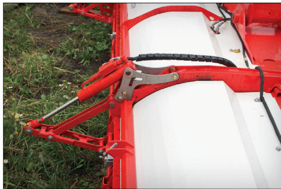
Kryty šnekového dopravníku CrossFlow se u žací kombinace NovaCat A10 CF otevírají hydraulicky z kabiny traktoru. Díky tomu je možné pohodlně zvolit požadovaný způsob ukládání hmoty – na středový řádek, kombinované ukládání či kompletně na široko
