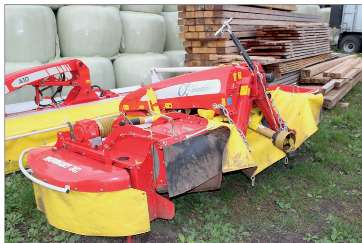
Aktivní nosný rám se u závěsu alpha motion stará o kvalitní kopírování terénu čelního žacího stroje NovaCat 301. Žací kombinace NovaCat A10 umí pracovnímu záběru tři metry tohoto stroje přizpůsobit úroveň překrývání svých žacích jednotek i automaticky
