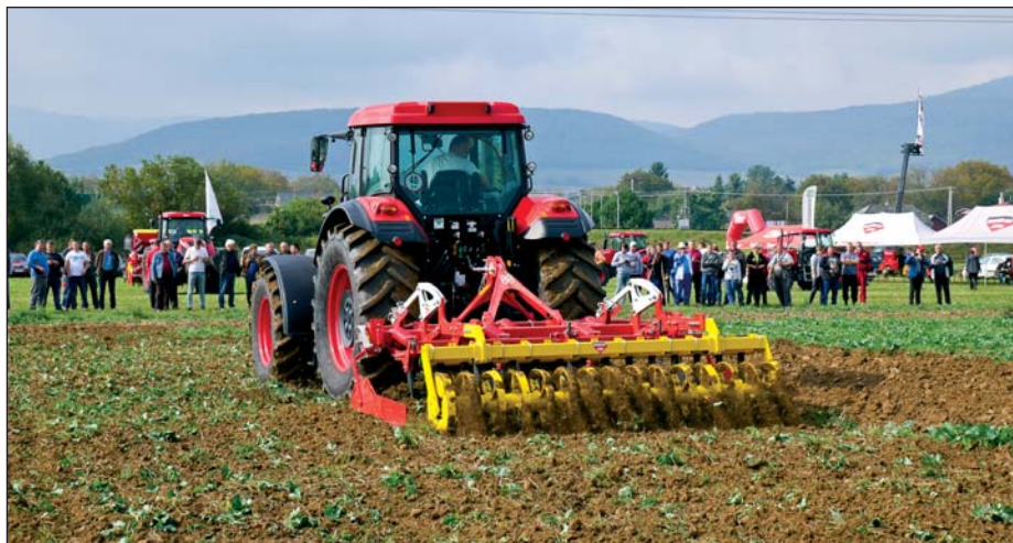
Kvalitnú prácu predviedol radličkový kyprič Synkro – v množstve podnikov používaný ako univerzálne náradie pre viac typov operácií. Životnosť pracovných orgánov zvyšuje tvrdomávanie.
