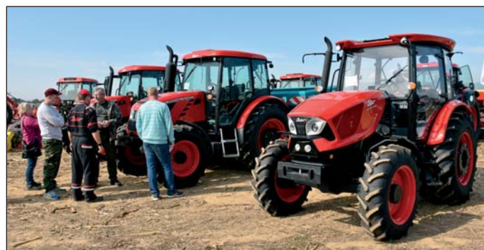
Proxima, Crystal a Forterra sa redizajnujú do konca roka 2020 podľa vzoru Majora (v popredí) navrhnutého v dizajnerskom štúdiu Pininfarina. Proxima (druhá sprava) patrí k najpredávanejším radom Zetorov. Vyrába sa v troch verziách líšiacich sa typom prevodovky. Jeho zaujímavosťou je vývodový hriadeľ s možnosťou otáčania vľavo aj vpravo.
