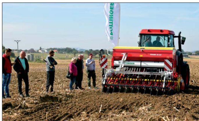
Nadstavbový sejací stroj Vitasem s dvojkotúčovou výsevnou pätkou a utlačovacím kolieskom v agregácii s rotačnými bránami, sa po orbe predviedol v dobrom svetle.
