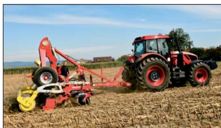
Terradisc, v tomto prípade ako 5 m, pred dvoma rokmi narástol až na záber 10 metrov, priemer tanierov je 580 mm.
