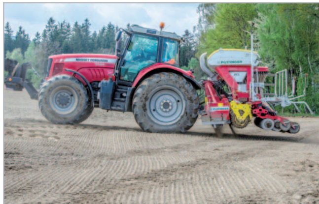
Rychlé otočení do další jízdy, a to i na malých pozemcích s nepravidelnými tvary, je výhodou neseného provedení secí kombinace. V závislosti na podmínkách se za den zaseje 25 až 30 hektarů
