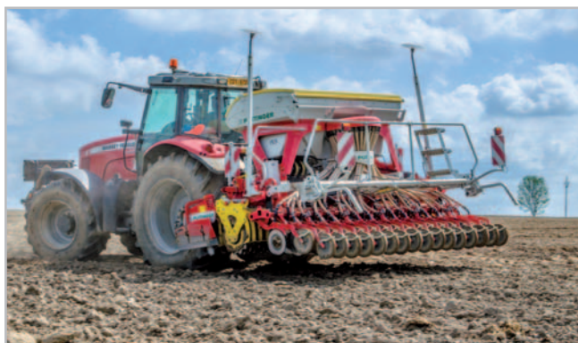
Traktor Massey Ferguson 7495 Dyna-VT na pneumatikách Michelin XeoBib zvládá secí kombinaci hravě, jak co se týká zvedací síly, tak i při samotné práci. Kukuřice se vysévá přímo do hrubé brázdy, s níž si dlouhé hřeby rotačních bran Lion 4002 snadno poradí
