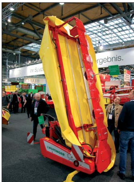
Bočná žacia lišta Novadisc 352 s pracovným záberom 3,46 metra.
