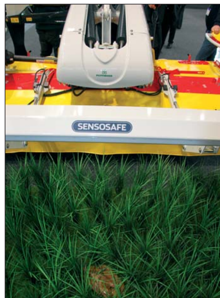
Systémom Sensosafe je možné vybaviť čelné aj bočné žacie lišty, vrátane kombinácií.
