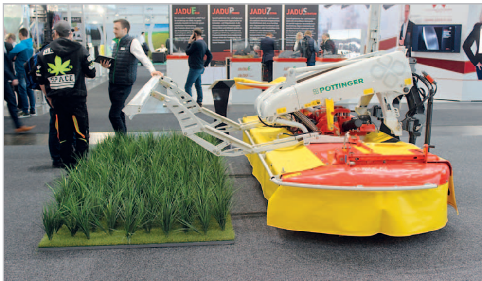
První variantou je nosník Sensosafe, umístěný přímo na čelně neseném žacím stroji. Pokud k detekování zvěře dojde, je vyslán signál na hydraulický systém žacího stroje, který je bleskově automaticky vyzdvihne z pracovní polohy Foto Petr Beneš
