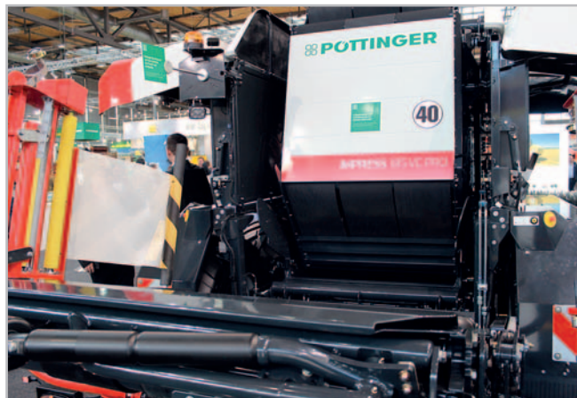
I největší balíky jsou plynule podávány na ovíjecí stůl, u kterého je těžiště uloženo nízko. Kombinace Impress 185 VC Pro tak plynule pracuje i na svažitéch loukách Foto Petr Beneš
