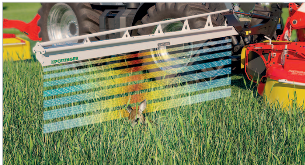
Kontrolovat výskyt zvěře v porostu před žacím strojem bude již brzy umět systém Sensosafe Foto archiv
