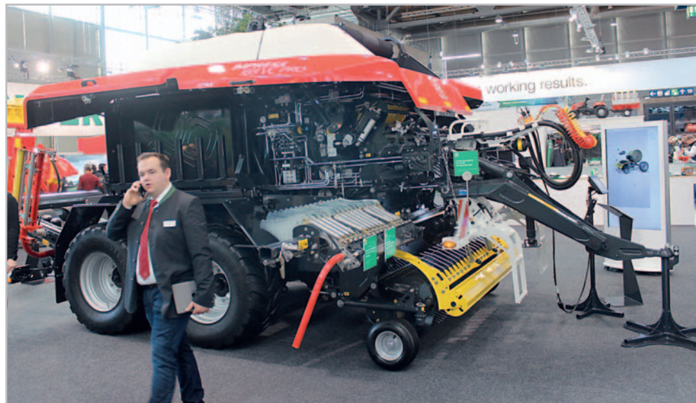
Nový největší model lisu s variabilní lisovací komorou Impress 185 VC Pro bude díky flexibilitě v oblasti průměru balíku od 0,9 do 1,85 m vhodným sklizňovým strojem pro proměnlivé podmínky, například u poskytovatelů služeb Foto Petr Beneš
