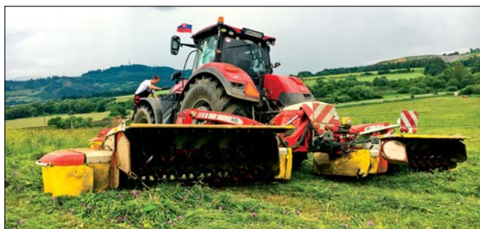
Výkonnosť krmovínárskej linky sa výrazne zvýšila s novou žacou kombináciou Novacat A 10 ED + Novacat 351 Alpha ED, ktorá je vybavená pre lepšie zavädnutie hmoty prstovým kondicionérom a jej pracovný záber je nastaviiteľný v rozmedzí od 8,8 až do 10 metrov.
