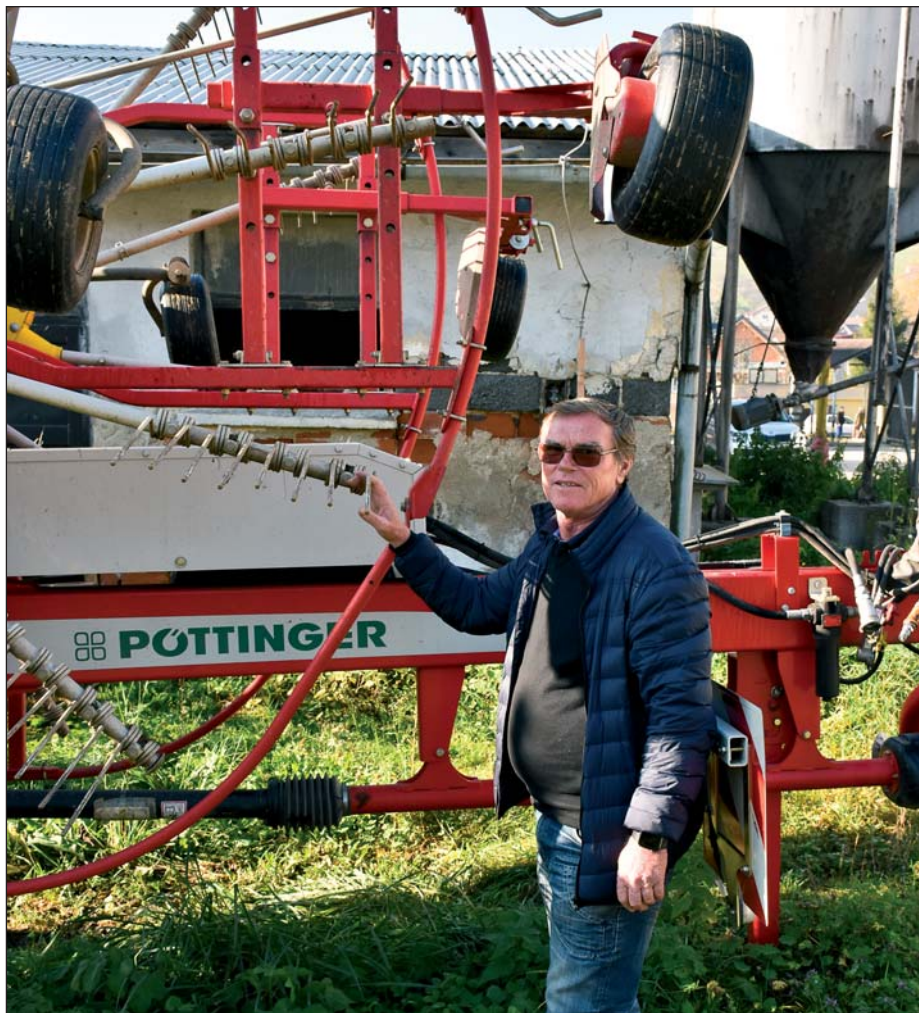
Miroslav Hladký, mechanizátor a člen predstavenstva PD Likavka, pred novým štvorrotorovým zhrabovačom Pöttinger TOP 1252. Aj keď je pracovný záber stroja až 12,5 metra, bezproblémovo a kvalitne pracuje tiež na miestnych značne svahovitých pozemkoch.
