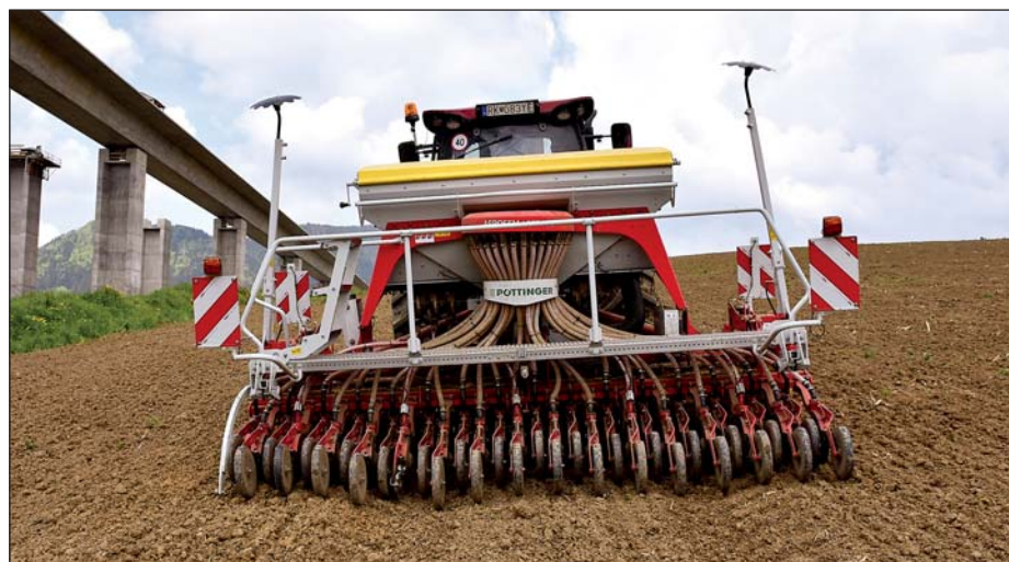
Univerzálny štvorrotorový pneumatický sejací stroj AEROSEM 4002 ADD PCS s rotačnými bránami LION 403. Veľmi sa osvedčil pri zakladaní porastov všetkých plodín, vrátane kukurice s príhnojovaním.
