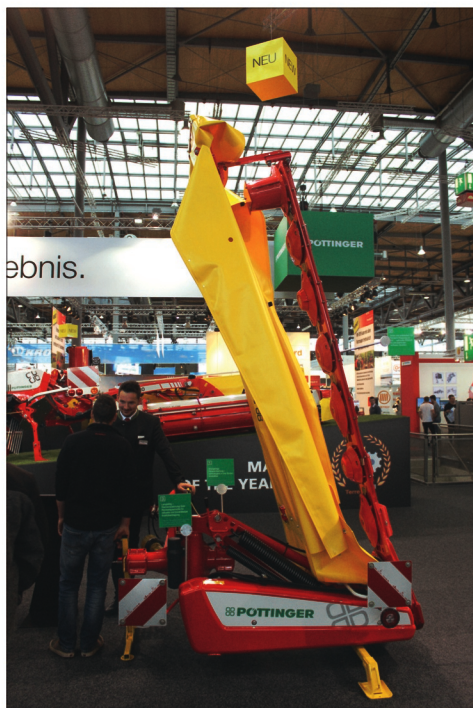
U vzadu nesených žacích strojů Novadis byla optimalizována poloha těžiště pro bezpečnější přesuny po silnici. V transportní poloze jsou tyto stroje sklopeny v úhlu 102 stupňů, což mimo jiné poskytuje i volný výhled dozadu z kabiny traktoru pomocí obou zpětných zrcátek
