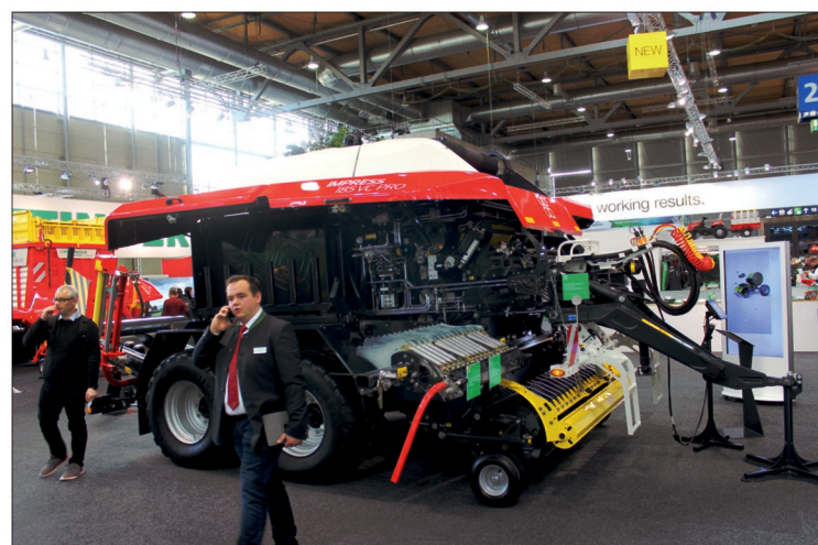
Nový největší model lisu s variabilní lisovací komorou Impress 185 VC Pro bude díky flexibilitě v oblasti průměru balíku od 0,90 do 1,85 m vhodným sklizňovým strojem pro proměnlivé podmínky – například u poskytovatelů služeb
