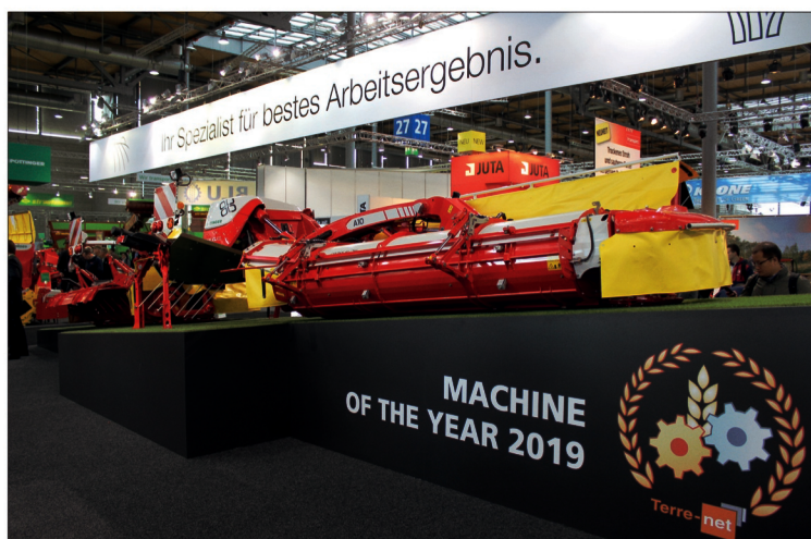
NovaCat A10 Cross Flow se vyznačuje sníženou hmotností, vyžaduje méně výkonu traktoru a s píčí manipuluje obzvláště šetrným způsobem. Šnekový dopravník píčí při dopravě ke středu žací kombinace obrací a tím urychluje její zavádění
