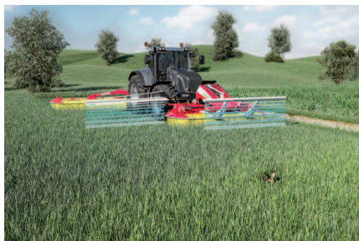
Obr.: Vizualizace systému Sensosafe v kombinaci s čelním a bočním žacím strojem
