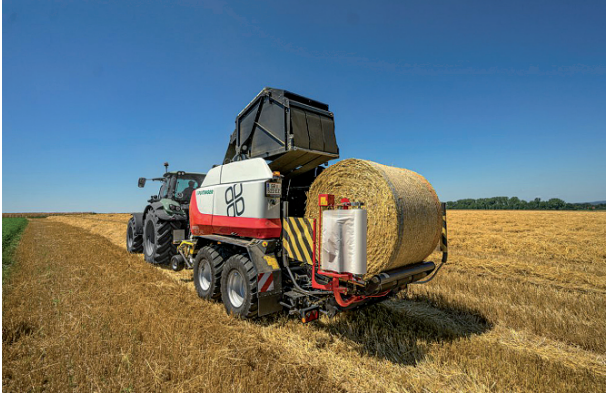
Obr.: Nový Impress dokáže lisovat balíky s průměrem 185 centimetrů
