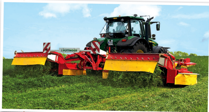
Žací kombinace NovaCat A10 může být na přání vybavena systémem automatického příčného posuvu tak, aby bylo při sečení možné na maximum využívat pracovní záběr stroje
