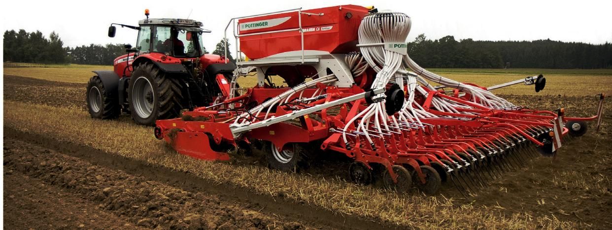
Systém Seed Complete zajišťuje průběžné ovládání dávkovaného množství (osiva/hnojiva) a automatické zapínání a vypínání dávkování na úvratí pozemku, ale i čtení map pro lokálně variabilní výši výsevku
