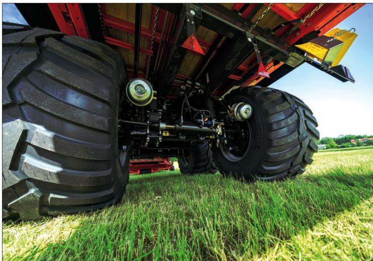
U inteligentní nápravy s náběžným řízením dojde automaticky k uzamčení řízení ve chvíli, kdy návěs dosáhne určitých předem definovaných hodnot například svým nakloněním či rychlosťí jízdy. Systém je k dispozici pro návěsy řad Faro, Europrofí, Torro a Jumbo (na obrázku)
