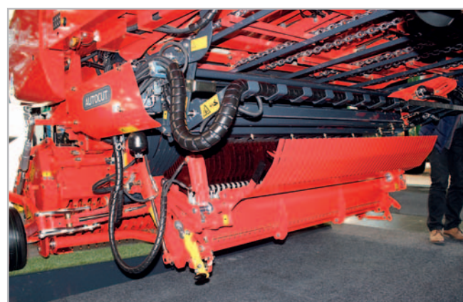
Plně automatické brousící zařízení Autocut je pro nové návěsy v určitých prvcích rovněž zdokonalené. Kromě snížení spotřeby paliva se také ušetří hodně času, protože nože mohou být broušeny v přestávkách práce bez nutnosti jejich demontáže
