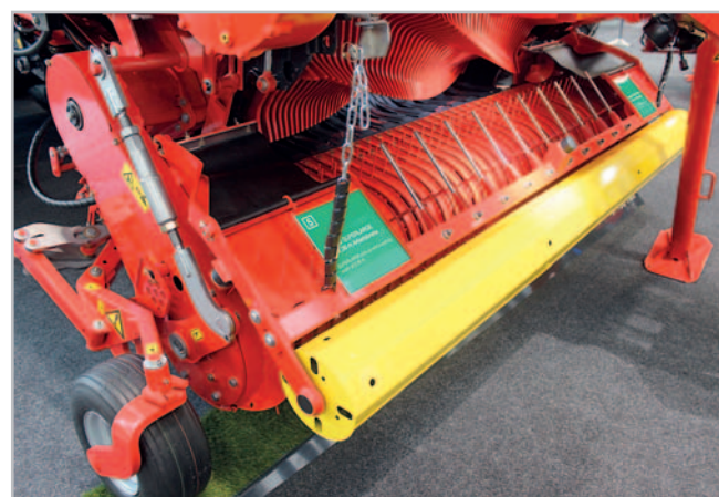
Šířka sběrače Superlarge u vozu Jumbo CombiLine 7220 L činí 236 cm, čímž je způsobily k plynulé sklizni i velmi širokých rádků. Sběrač je osazen prsty Durastar o síle šesti milimetrů v sedmi řadách
