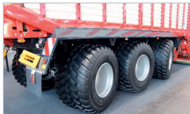
Inovace se dotýká i podvozku, kdy provedení Tridem je dostupné i pro menší model Jumbo CombiLine 7220. Charakteristika odpružení se bude umět ještě citlivěji adaptovat úrovni zatížení návěsu
