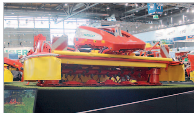
Nové typy čelně nesených žacích strojů NovaCat Alpha motion Pro se připojují přímo k přednímu tříbodovému závěsu traktoru. Osvědčená kinematika nosného rámu se uplatňuje ve shodné míře, takže žací nosník je rovnoměrně veden po sečeném terénu
