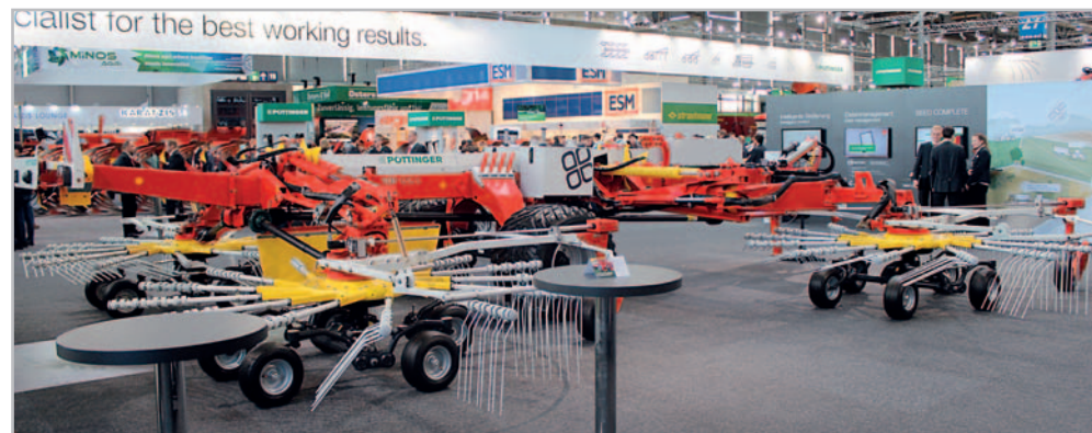
Největší čtyřrotorový shrnovač TOP 1252C nemusí vždy pracovat na plný pracovní záběr 12,5 m, ale šířku záběru je možné plynule hydraulicky měnit až do 8,5 m. A to u obou předních rotorů společně či jenom na jedné straně, takže lze precizně shrnovat píci i na malých pozemcích či v klínech
