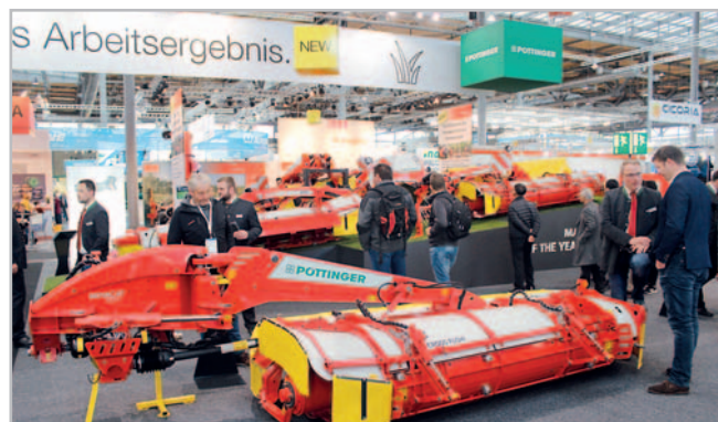
Se systémem Cross Flow se představily vzadu nesený žací stroj NovaCat 302 CF a žací kombinace NovaCat A10 CF. Šnekový dopravník píci při dopravě ke středu žací kombinace obrací a tím urychluje její zavádění
