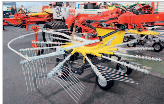
Hrabice rotorů lze snadno demontovat uvolněním dvojice šroubů. Přední dva rotory u shrnovače Top 1252C jsou poháněny hydraulicky, zadní pak mechanicky; pomocí hydrauliky se z kabiny traktoru u všech rotorů nastavuje výška prstů nad zemí
