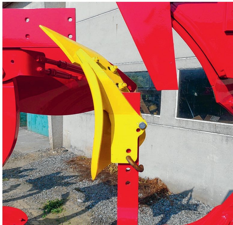
De diepte en de voorwaartse stand van deze ploeg kunnen geregeld worden. Foto: NH
