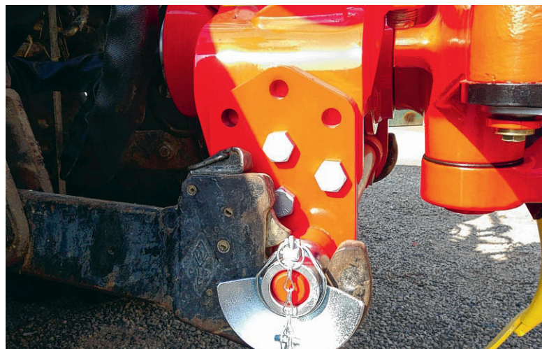
De bevestigingspunten van de koppelstang kunnen op deze ploeg aangepast worden. Foto: NH
