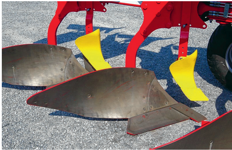
Op dit rister, bestaande uit twee stukken, is de kop onafhankelijk. Foto: NH
