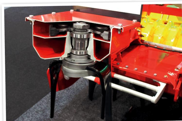
Rotační brány Lion série 1003 jsou osazené integrovaným unašečem hřebů, díky čemuž nedochází k zaklínění kamenů. Vysoká, svařovaná převodová vana je osazena kuličkovými ložisky a je dostatečně stabilní. Převodovka dovoluje agregaci traktorů o výkonu až 250 k
