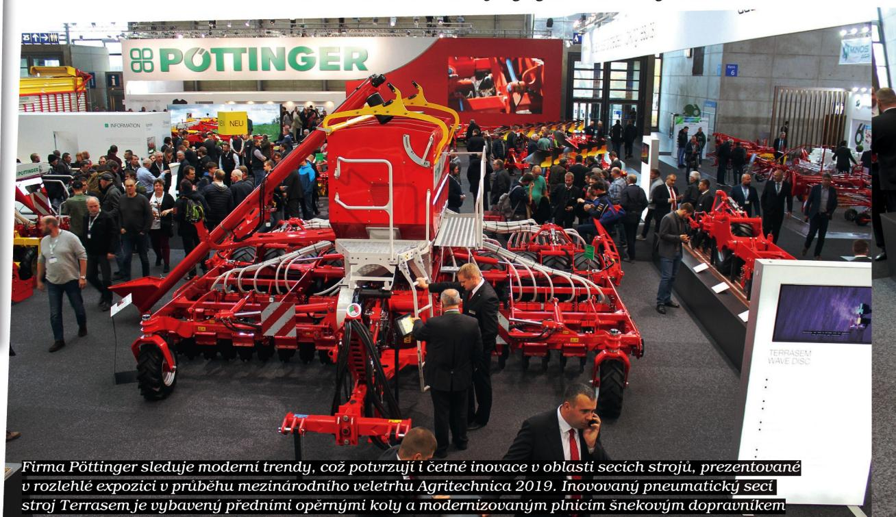
Firma Pöttinger sleduje moderní trendy, což potvrzuje i četné inovace v oblasti secích strojů, prezentované v rozlehlé expozici v průběhu mezinárodního veletrhu Agritechnica 2019. Inovovaný pneumatický secí stroj Terrasem je vybavený předními opěrnými koly a modernizovaným plnicím šnekovým dopravníkem
