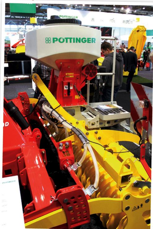
Od podzimu 2019 se rozšiřuje možnost využití secího stroje Tegosem i pro všechny modely rotačních bran Lion s pevným rámem a krátké kombinace na přípravu půdy Fox. Vyústění semenovodních hadic může být bud' před opěrným válcem anebo za ním
