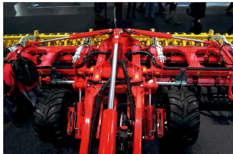
Větší model talířových podmítačů Terradisc 10001 T Je standardně vybavený centrálním hydraulickým přestavováním hloubky záběru. Jednotlivá sklopná pole se povrchu pozemku individuálně přizpůsobují a celý stroj tak působí na půdu šetrně
