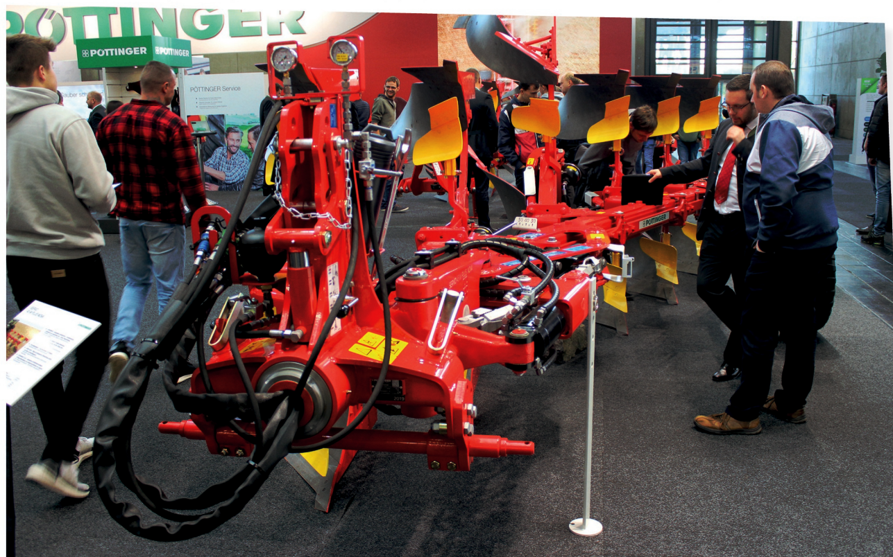
Servo 45 M je nová řada nesených pluhů firmy Pöttinger pro traktory s výkonem od 140 do 240 k. Na veletrhu Agritechnica byla představena nejnovější varianta se šesti páry orebních těles, navíc ještě vybavená předradličkami a systémem Traction Control
