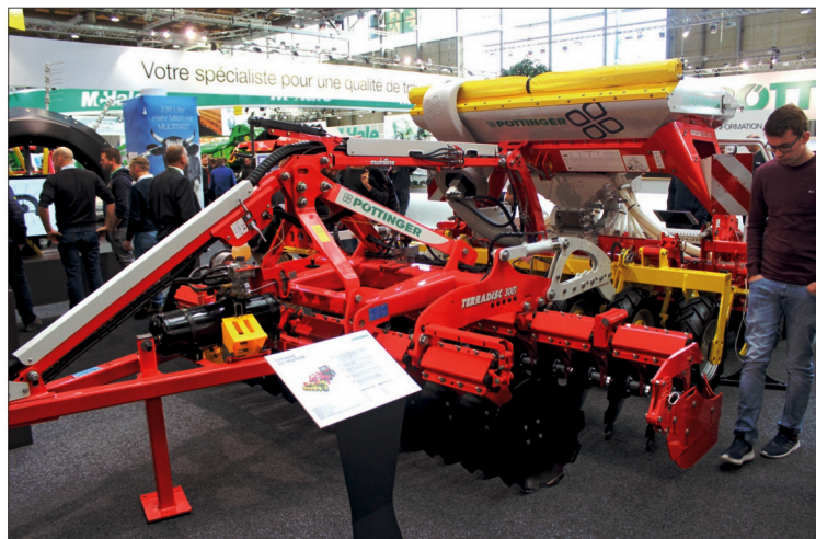
Na rozdíl od prvních strojů se druhá generace Pöttinger Multiline vyznačuje přepracováním opěrného válce. Jednotlivá kola jsou uložena v přesazení, čímž se docílí lepší stability za jízdy na nerovném povrchu i při přejezdech po silnici
