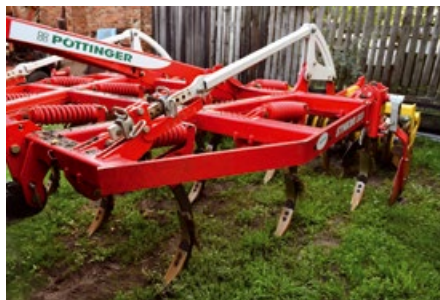
Nejvyužívanějším strojem na zpracování a přípravu půdy je radličkový podmiťáč SYNKRO 3030 NOVA z roku 2016.
