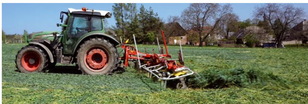
Posečenou hmotu rovnoměrně rozdodí obrabeč HIT 8.81 vybavený osmi rotory se záběrem 7,7 metru.
