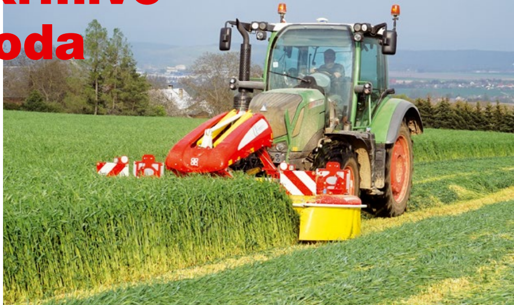
Čelní žací stroj NOVACAT 301 F ALPHA MOTION šetrně kopíruje nerovnosti a seče čistou hmotu bez příměsí.
