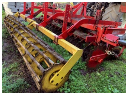
Diskový podmiťáč TERRADISC 4000 z roku 2010 dělá hlavně první podmiťky po sklizni.
