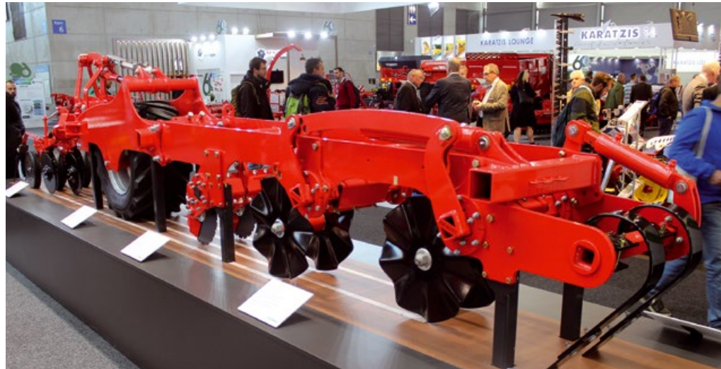
Díky promyšlené kombinaci pracovních orgánů zajišťují pneumatické secí stroje TERRASEM kvalitní přípravu půdy, uložení hnojiva i výsev při jednom přejezdu. Zvlněné talíře WAVE DISC v systému Low Disturbance provádějí přípravu půdy v pásech, do kterých je následně uloženo osivo.
