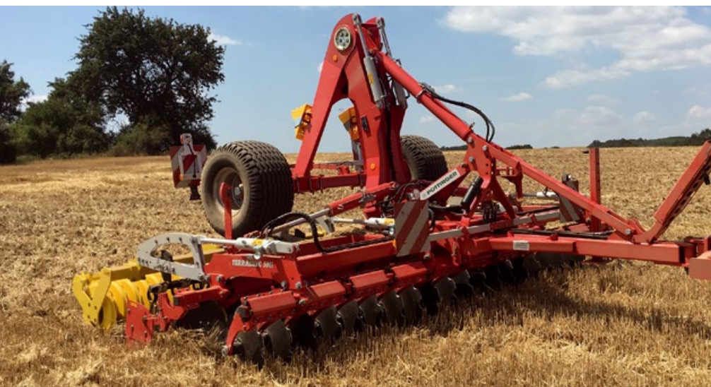
V družstve vyskúšali diskový podmietač TERRADISC 5001 T (na snímke). Nakoniec sa rozhodli pre stroj s pracovným záberom šesť metrov TERRADISC 6001 T.
