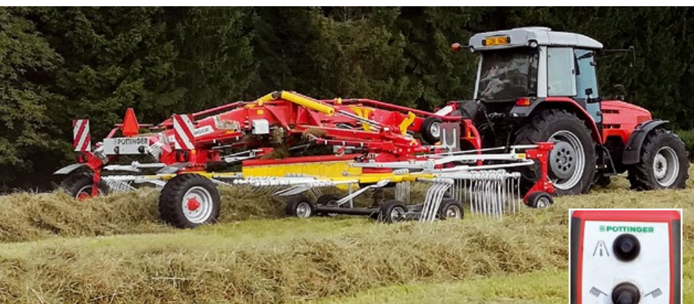
Dvourotorový shrnovač TOP 842 C sbírá píci z 8,4 metru do pravidelného středového řádku. Vybavený je jednoduchým ovládacím panelem DIRECT CONTROL.
