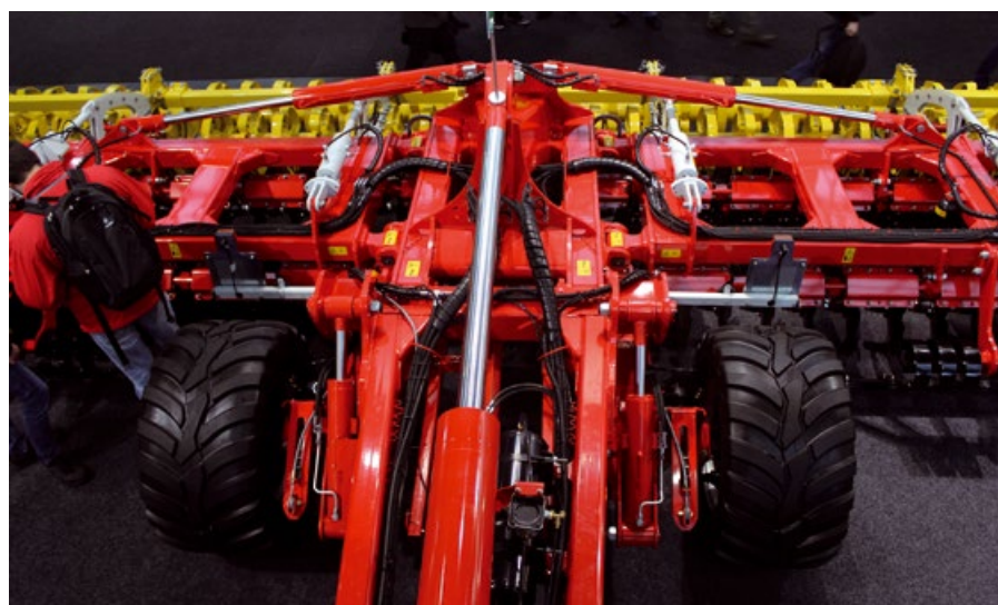
Velké verze talířových podmítačů TERRADISC 8001 T a 10001 T se záběrem osmi a deseti metrů mají optimalizovaný tvar, velikost, úhel a zešikmení talířů. Dvě masivní, kované slupice jsou přivařené vždy na jednu objímku s velkou šířkou. Díky tomu si talíře vždy zachovávají svoji polohu a nastavení.
