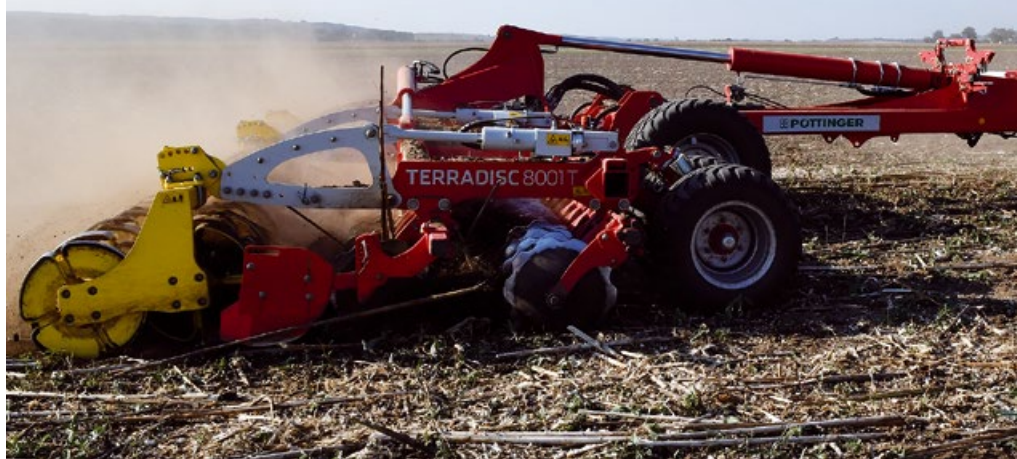
Polonesený diskový podmietač TERRADISC 8001 T s pracovným záberom osem metrov je univerzálny stroj do všetkých pôdnych podmienok. Použitelný je na podmiatku i predsejbovú prípravu.
