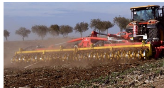
Veľký záber diskového podmietača pri pracovnej rýchlosti až 18 km/h zaručuje vysokú plošnú výkonnosť.
