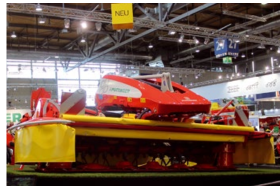
Nové typy čelně nesených žacích strojů NOVACAT ALPHA MOTION PRO se připojují přímo k přednímu tříbodovému závěsu traktoru. Osvědčená kinematika nosného rámu se uplatňuje ve shodné míře, takže žací nosník je rovnoměrně veden po sečeném terénu.
