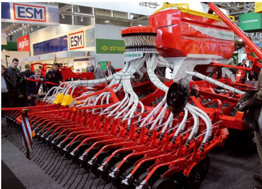
Díky rozdělovací hlavě IDS mají secí stroje TERRASEM široké možnosti nastavování meziřádkové vzdálenosti i rytmu, rozchodu a šířky kolejových řádků.
