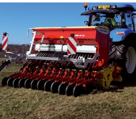
V minulém roce pořídili na farmu v Jiříkově krátkou kombinaci FOX 300 s mechanickým secím strojem VITASEM 302 ADD. Kombinace výborně zvládá přísevy a obnovu trvalých travních porostů.
