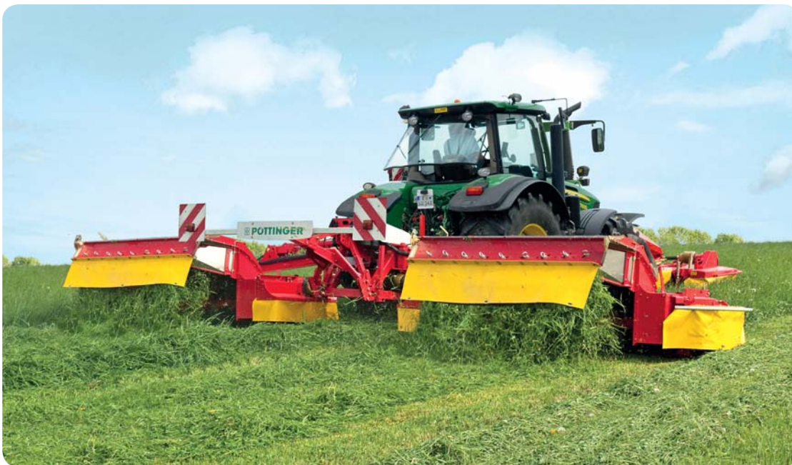
Žací kombinace NovaCat A10 může být na přání vybavena systémem automatického příčného posuvu tak, aby bylo při sečení možné na maximum využívat pracovní záběr stroje
