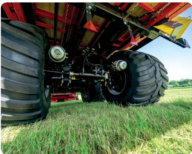
U inteligentní nápravy s náběžným řízením dojde automaticky k uzamčení řízení ve chvíli, kdy návěs dosáhne určitých předem definovaných hodnot například svým nakloněním či rychlostí jízdy. Systém je k dispozici pro návěsy řad Faro, Europrofi, Torro a Jumbo (na obrázku)
