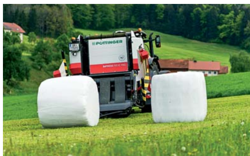
Lisy s obalovačkou majú dvojitú nápravu. Balíky možno vypúšťať po dvoch, čo uľahčuje a urýchľuje následný zber a zvoz.
