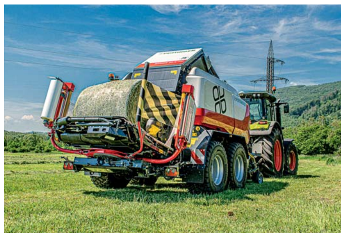
Lis s obalovačkou má kompaktné rozmery vďaka konštrukcii s dvoma ramenami pohybujúcimi sa zdola nahor.
