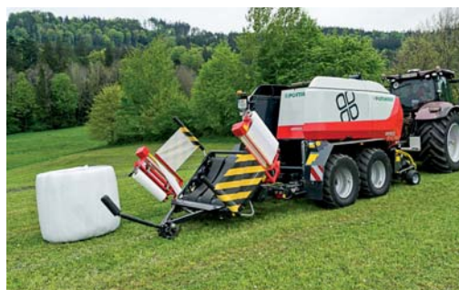
Bezpečnostný prvok na svahovitých pozemkoch - balíky sa ukládajú nabok, čo znižuje riziko skotúľania sa dole svahom.
