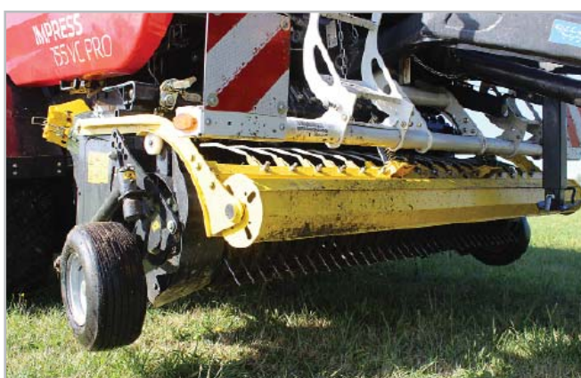
Sběrač lisů Impress VC Pro o šířce 2,3 m je tradičně řízený. Díky svému příčnému výkvnému uložení zajišťuje čistý a plynulý sběr píce z řádku. I velký objem těžkého materiálu je tou nejkratší možnou cestou hladce zakládán do prostoru plnicího rotoru Foto Petr Beneš
