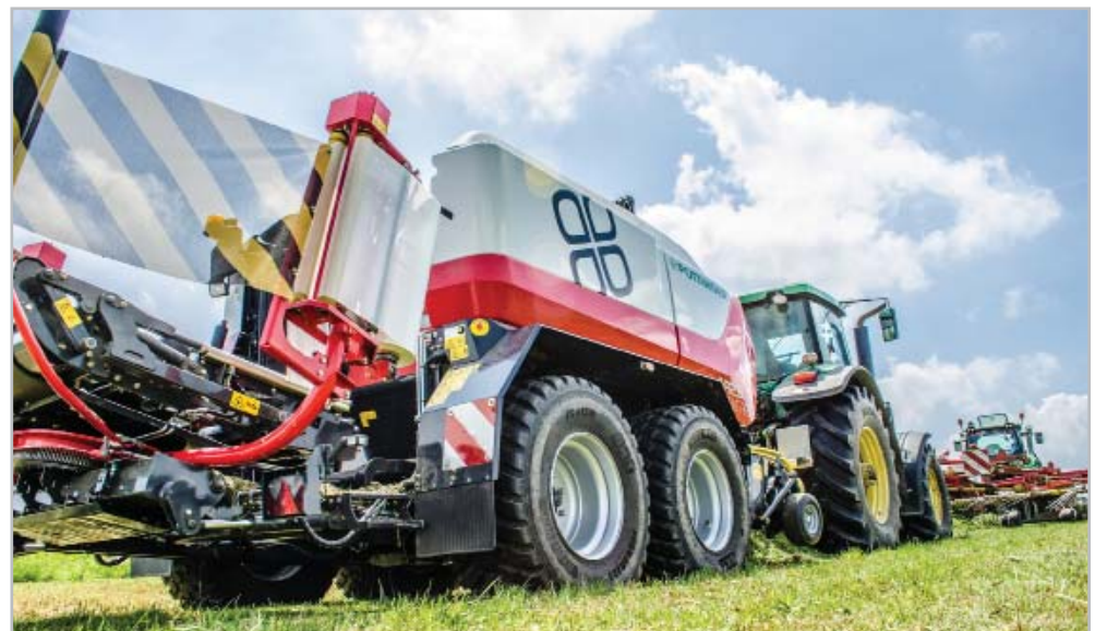
Po zkrácení píce pomocí nožů hmotu přebírají dva válce s dostatečně agresivním působením k tomu, aby zvládly spolehlivě založení jádra balíku. Poté spolehlivě zachytí hmotu i tři široké nekonečné pásy, které se postarají o její stlačení a zformování balíku do požadovaného tvaru Foto Petr Beneš
