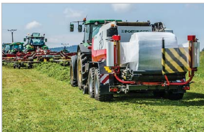
Hned zpočátku překvapila kombinace lisu s ovíječkou na jednom podvozku Impress 155 VC Pro svou výkonností. Při sklizni senáže mají balíky o průměru 120 cm hmotnost nejméně 600 kg Foto archiv
