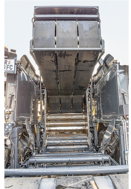
Die Kammer hat vier Walzen und drei Riemen, die Geometrie bildet eine sehr kleine Kammer, die das Futter von Anfang an verdichtet.
