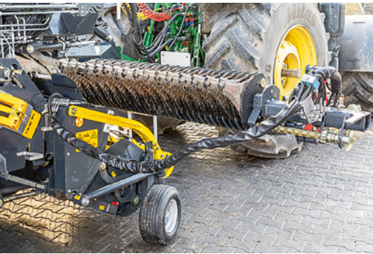
Die Messerschublade lässt sich nach dem Entriegeln nach rechts ausziehen.
