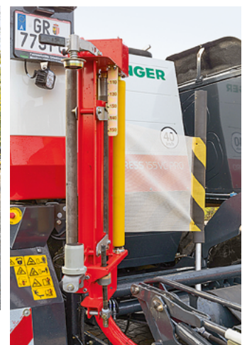
Der Wickler arbeitete störungsfrei. Die Parallelogrammverstellung erlaubt das Wickeln unterschiedlicher Durchmesser.
