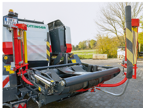
Der Wickler arbeitete störungsfrei. Die Parallelogrammverstellung erlaubt das Wickeln unterschiedlicher Durchmesser.
