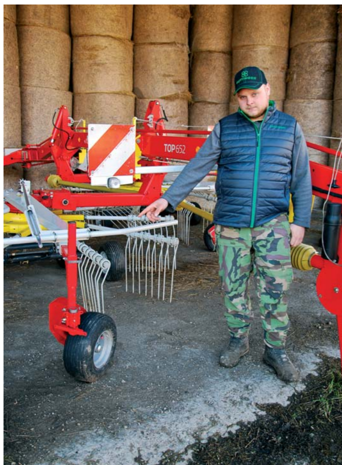
Dávid Kozoň si pochvaľuje kopírovacie koliesko, ktoré zlepšuje zhrňanie a aj kvalitu krmoviny.
