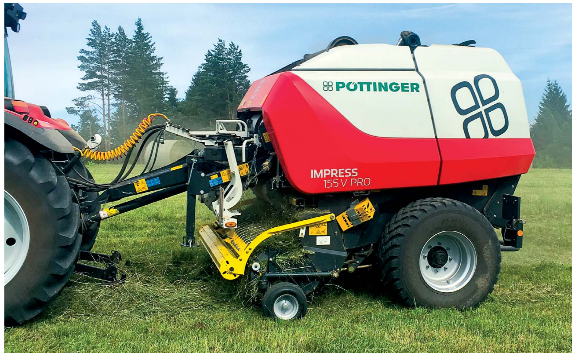
Lis s variabilnou lisovacou komorou IMPRESS 155 V PRO pri zbere sena.
