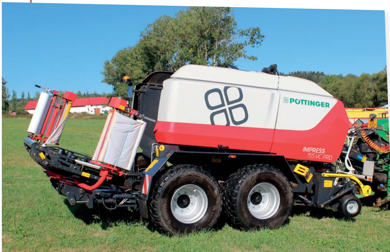
Pro ovládání kombinace lisu s baličkou Pöttinger Impress je nový terminál CCI 1200 s velkou obrazovkou ideální rozhraní. Navíc může také zobrazovat výstup z kamery, sledující činnost integrované baličky
