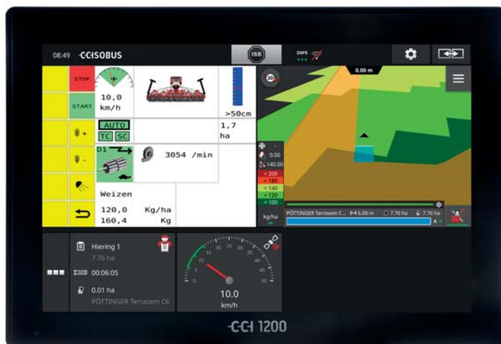
Terminál CCI 1200 otevírá cestu do světa precizního zemědělství. Na jedné části obrazovky může být zobrazeno ovládání secího stroje Terrasem, na další pak mapa pozemku s variabilním výsevem a aktivním systémem Section Control
