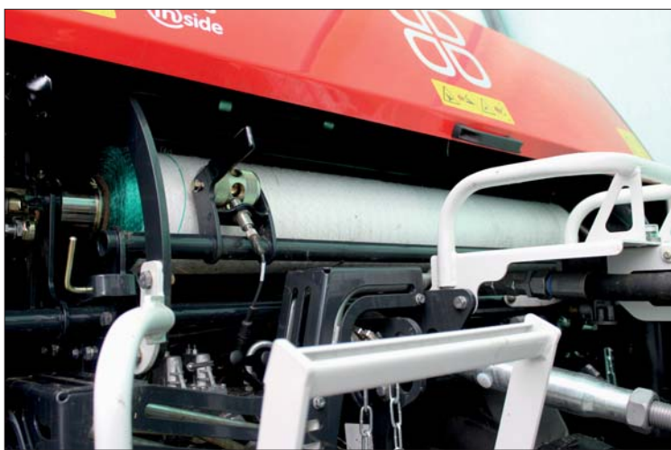
Vkládání nových rolí sítě je rychlé a jednoduché. Od roku 2020 umí kombinace lisu s baličkou na jednom podvozku Impress firmy Pöttinger na přání také vázat balíky místo sítě fólií
