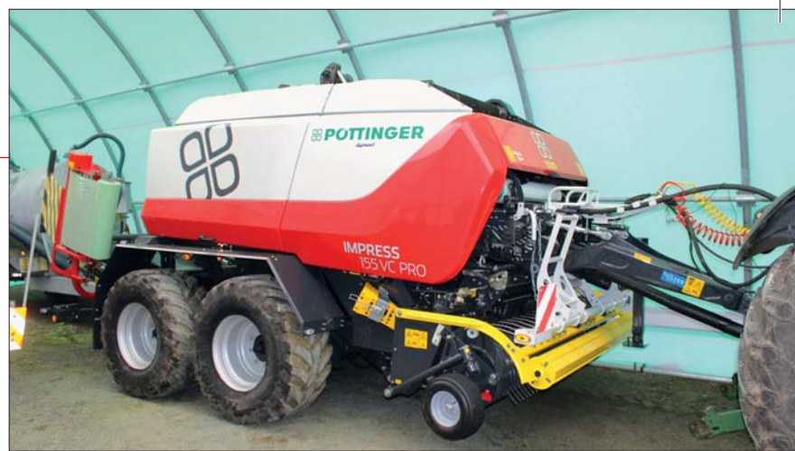
Pöttinger Impress 155 VC Pro představuje vydařené spojení mnohožového řezacího ústrojí, výkonného lisu s efektivním plněním lisovací komory a moderní dvouramenné baličky
