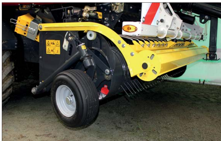
Sběrač lisu Impress 155 VC Pro o šířce 2,3 m je osazený předsazeným vkládacím válečkem o průměru 200 mm a výškově nastavitelným nárazovým plechem, které zaručují plynulý tok materiálu. Při nasazení na nerovných loukách výkonný sběrač přesvědčil svou schopností kopírování terénu
