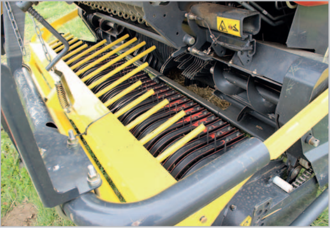
Aktivní sběrač dokáže zajistit plynulý sběr jakéhokoliv materiálu, i krátké a lámavé slámy. Je doplněn výškově nastavitelným nárazovým plechem s předsazeným vkládacím válečkem a vodicími pruty. Dva aktivně hnané šnekové dopravníky zajišťují rovnoměrné vedení materiálu do lisovací komory
