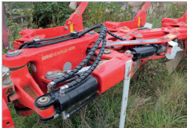
Fungování prvního hydraulického válce v praxi si zasloužilo uznání, protože samočinně „stáhne“ pluh před jeho otočením na souvratí a pak opětovně vrátí do původní polohy, takže obracení je rychlé a plynulé. Další válec plynule ovládá pracovní záběr orebních těles Foto Petr Beneš
