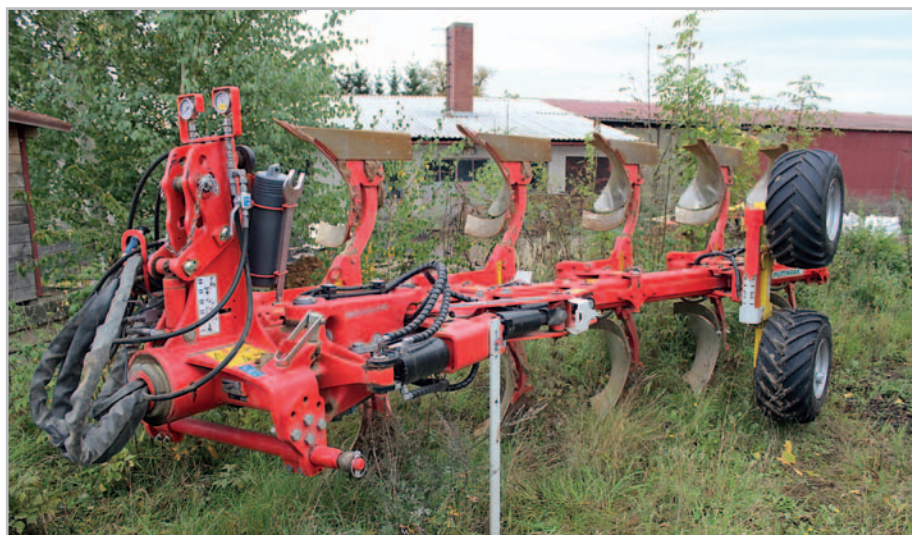
Pluh Servo 45 M Plus Nova firmy Pöttinger na farmě Ing. Ladislav Chmelík je ukázkou toho, jak se bohatá výbava v praxi výborně uplatní pro zvýšení kvality i produktivity práce. Dodatečně budou doplněny ještě předradličky Foto Petr Beneš
