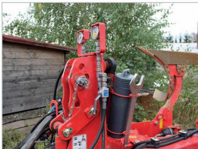
Prostřednictvím této „kolébky“ přenáší hydraulický válec systému Traction Control část ze zahlubovacích sil orebních těles jako přidavné dotížení na zadní nápravu traktoru. Tlak v systému je nastavitelný v traktoru, a lze jej sledovat na tlakoměru vpravo. Levý tlakoměr ukazuje tlak v systému nonstop jištění Foto Petr Beneš
