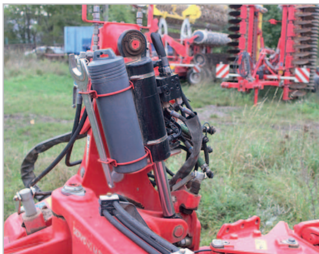
Praktický detail: do šedé schránky si lze uložit střížné šrouby, ráčnu a návod k použití. V bezpečném místě jsou vždy k dispozici, stejně jako plochý klíč pro nastavení tahové linie pluhu Foto Petr Beneš
