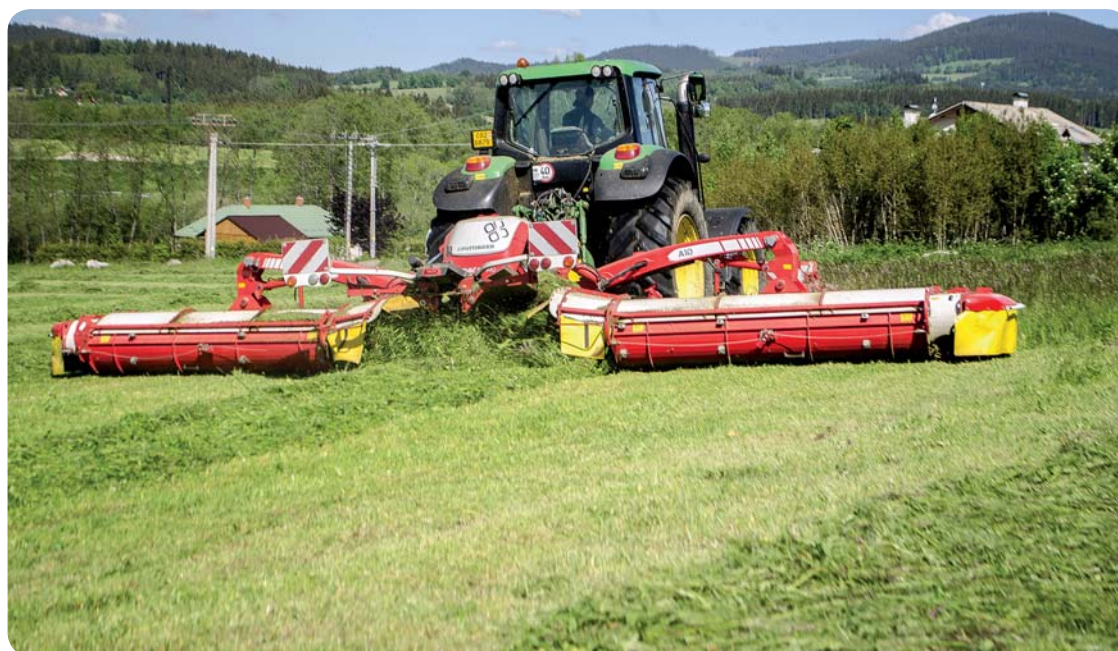
Využitím šneků, tedy současným řádkováním posečené píče, ušetří v Milné jednu pracovní operaci. Další velkou předností takto nařádkované píče je její čistota a minimální obsah příměsí
