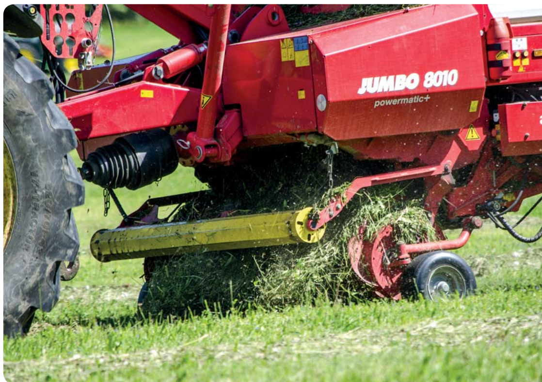
Posečenou a nařádkovanou píci sbírá senážní vůz vybavený řezacím ústrojím
