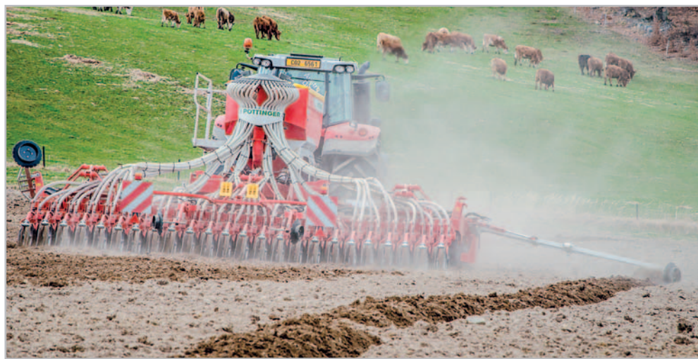
Sečí stroje Terrasem lze použít v různých technologiích, od orby přes seči do mulče až po seči do strniště Foto archiv AGROZET
