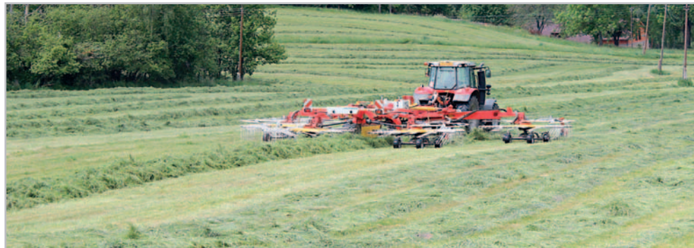
Eurotop 1252 C vytváří na hmotu bohaté řádky, rotory velmi dobře kopírují terén a píče je bez příměsí Foto archiv AGROZET
