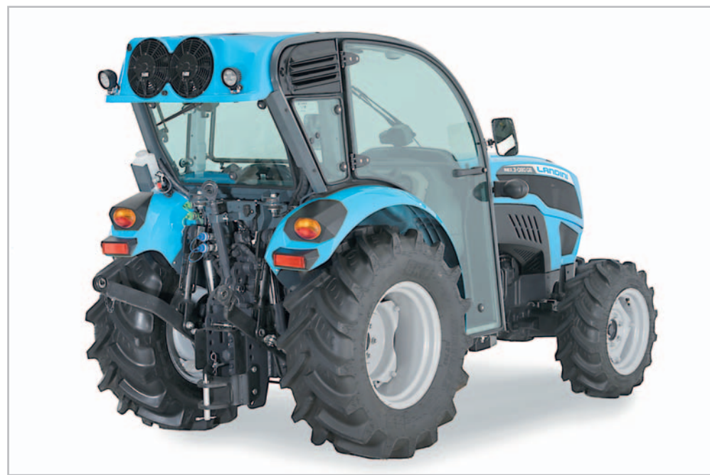
Landini REX 3-080 GE používá sníženou kabinu Foto archiv
