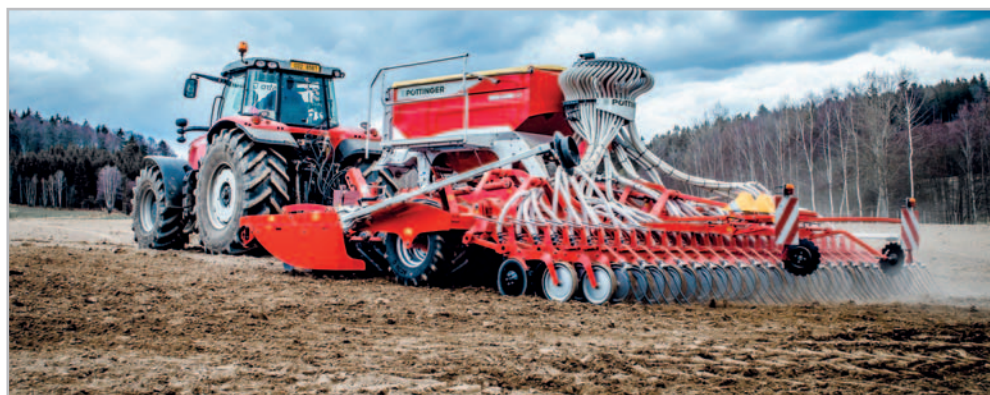
Univerzální sečí stroj Terrasem C6 je vybaven dvouřadým talířovým podmičákem, pneumatikovým válcem a nosníkem dvoudiskových botek Dual Disc. Proveďte předseťovou přípravu půdy, vytvoří seťové lůžko, uloží osivo a zpětně půdu utuží Foto archiv AGROZET
