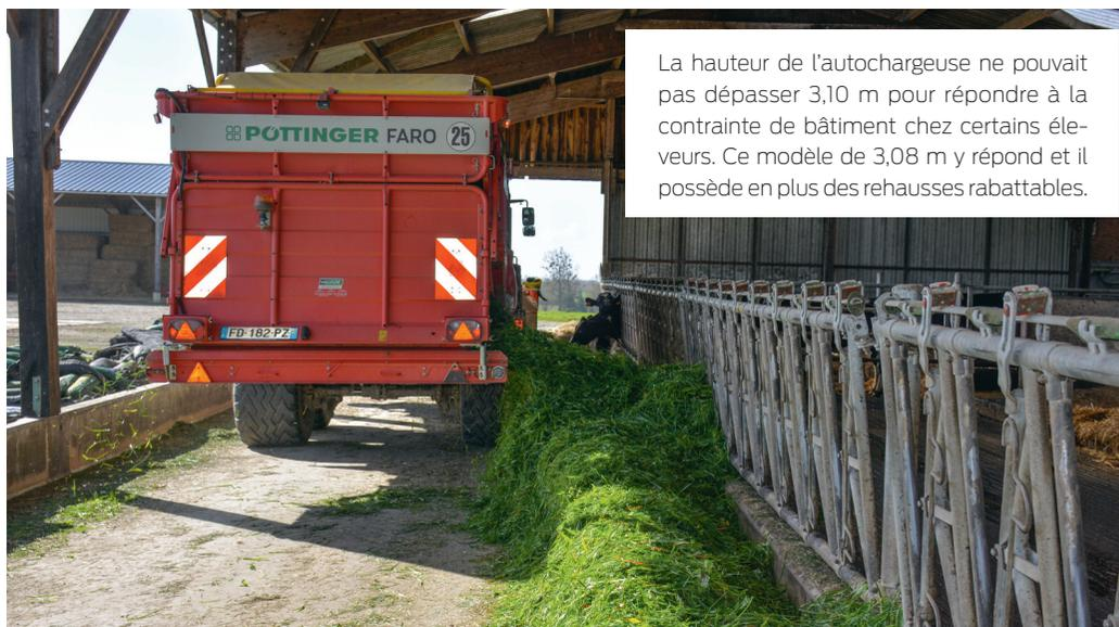
La hauteur de l'autochargeuse ne pouvait pas dépasser 3,10 m pour répondre à la contrainte de bâtiment chez certains éleveurs. Ce modèle de 3,08 m y répond et il possède en plus des rehausses rabattables.
