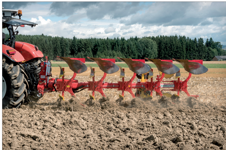
Otočné, nesené pluhy Pöttinger Servo 45 M jsou vyráběny ve čtyř- až šestiradičném provedení
