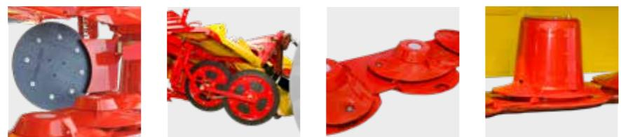
**NOVACAT – čelně nesené diskové žací stroje** Shazovací disky vnitřní / vnější Přídavné shazovací disky Zvýšené žací disky Disky s dopravními bubínky
