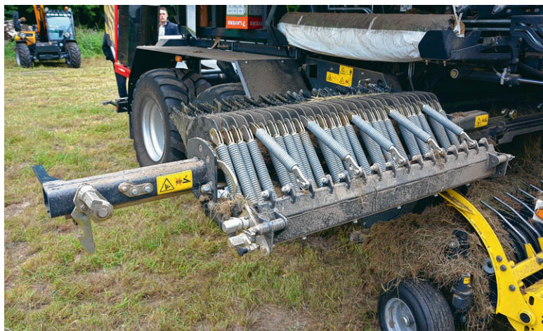
La barre de coupe Easy Move, située à hauteur d'homme, est facilement accessible pour l'entretien et le remplacement des couteaux. J.V.
