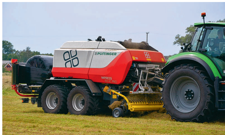
En version VC, l'Impress combine chambre variable et table d'enrubannage pour un travail complet en un seul passage. J.V.
